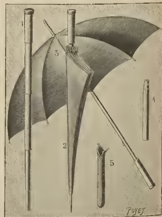
Fig. 2. Bastón paraguas. — 1. Bastón montado. — 2 y 3. Paraguas fuera del bastón, cerrado y abierto. — 4. Tubos concéntricos del bastón. — 5. Estuche para los tubos.
