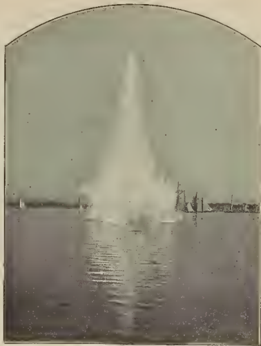
Fig. 6. - Mina cargada con 100 libras de dinamita
