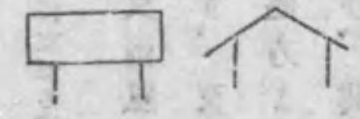
切妻造の型 前圖は正面 後圖は側面
