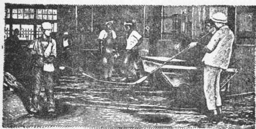
(左) 製玻璃管的方法 (右) 玻璃瓶在模型中吹成。
