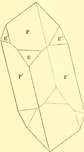
Mit diesem hexaederähnlichen Rhomboeder sind die Flächen des hexagonalen Prisma  $\infty P$  verbunden, wie man in Fig. 4 sieht und wenn diese Combination in der Richtung vier in einer Zone liegender Flächen unverhältnissmässig ausgedehnt wird, wie Fig. 5 angibt, so entsteht dadurch die an den Andalusit erinnernde Gestalt, welche dergleichen aus dem Grundgestein herausragende Krystalle zeigen.
