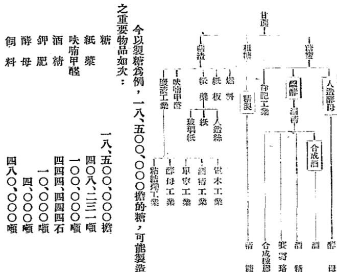
現在已經工業化者，除紙漿酒精外，僅有酵母工業，其他尚未普遍利用。實則其他各種工業，亦均有其重要性。譬如由蔗渣選用以製糖原料時，先通過篩子，其粉未狀之蔗渣，如加入漁粉、蛋白質、鹽類等，可用以製造牛馬豚雞之飼料；其次將蔗渣移入蒸解罐內，於高溫高壓之下，通入蒸氣蒸溜之，可得約當蔗渣五%之呋喃甲醇，此為潤滑油、清淨劑、琥珀酸、電玉等之原料。取去呋喃甲醇後之蔗渣，可用以製造紙漿，而其廢液中所含之角質及戊糖等，再可以製造酒精、單萘劑、粘結劑、電玉等物質。再如糖蜜可先製成酵母，而後提煉酒精，殘渣則製鉀肥。
