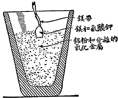
圖 65 用鋁粉從氧化物分離出金屬
