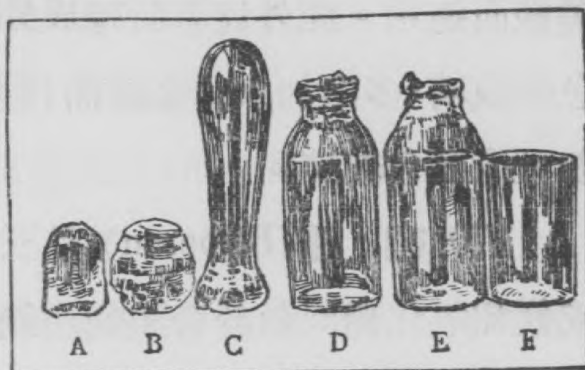
圖 63 製玻璃杯的程序
