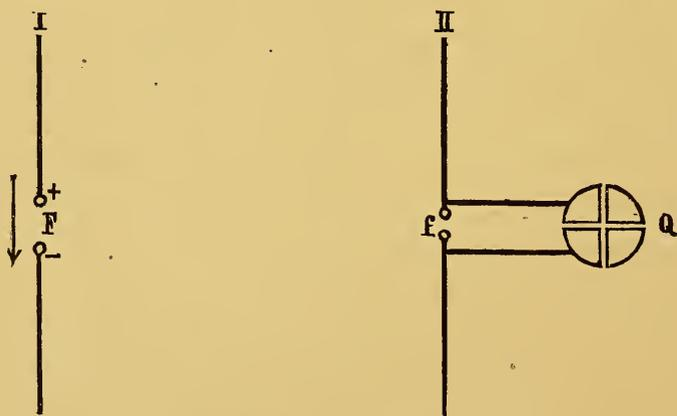
primären Funkenstrecke  $F$  lassen wir die positive Elektrizität von oben nach unten springen, in Folge dessen wird in der sekundären Funkenstrecke  $f$  zuerst durch  $+e$  die positive Elektrizität von unten nach oben und dann unmittelbar darauf durch  $-e$  von oben nach unten
