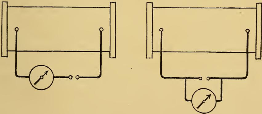
so zeigt das Galvanometer eine der Richtung des Oeffnungsstromes entsprechende Ablenkung an, welche mit Einführung der Funkenstrecke eintritt, bei Erweiterung derselben erst zunimmt, ein Maximum erreicht und dann wieder auf Null herabsinkt, wenn die Funkenstrecke so weit wird, dass keine Funken mehr springen. Eine Wirkung des entgegengesetzt gerichteten schwach gespannten Schliessungsstromes auf das Galvanometer erhält man durch eine Anordnung nach dem
