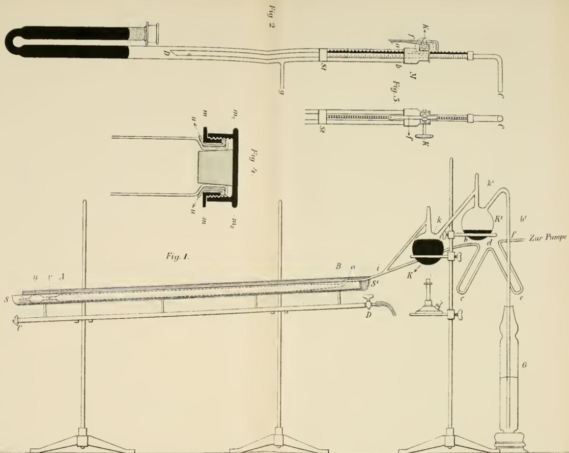
War der ganze Apparat zusammengeschnitten, so wurde derselbe, und mit ihm die Pumpe, durch eine Wasserpumpe nach Möglichkeit evakuiert. Natürlich war zwischen Apparat und Wasserpumpe eine Trocken-
