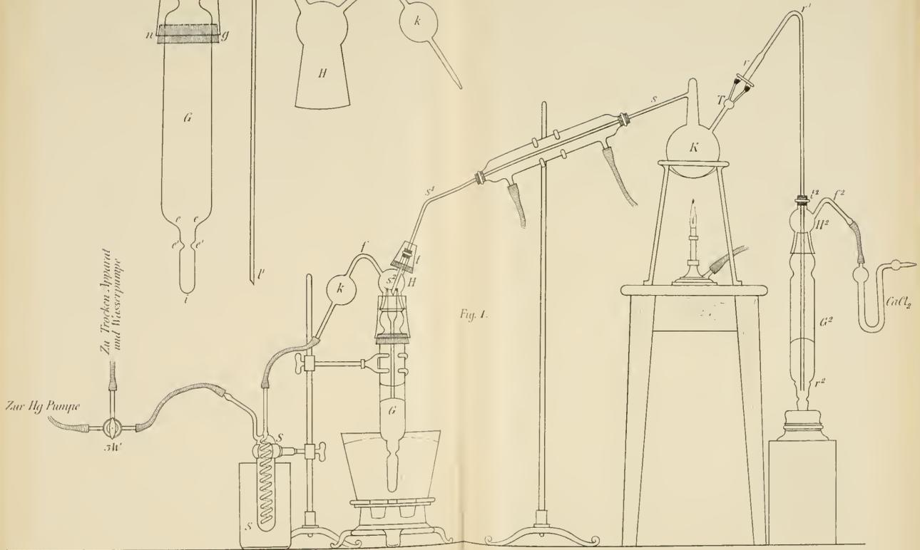
$K$  der Stutzen  $T$  aus, der in den Schliff endete, in welchen das Rohr  $r, r_1, r_2$  einpasste, das bei  $r$  senkrecht nach unten gebogen mit  $r_2$  in  $G_2$  unter Quecksilber tauchte; dasselbe war mittelst des Stutzen  $A_2$  durch den Helm  $H_2$  in  $G_2$  geführt.  $H_2$  war auf  $G_2$  aufgeschliffen und führte mit  $f_2$  zu einem Chlorcalciumrohr. Der Schliff des Stutzen  $T$  konnte mit Quecksilber in bekannter Weise gedichtet werden.
