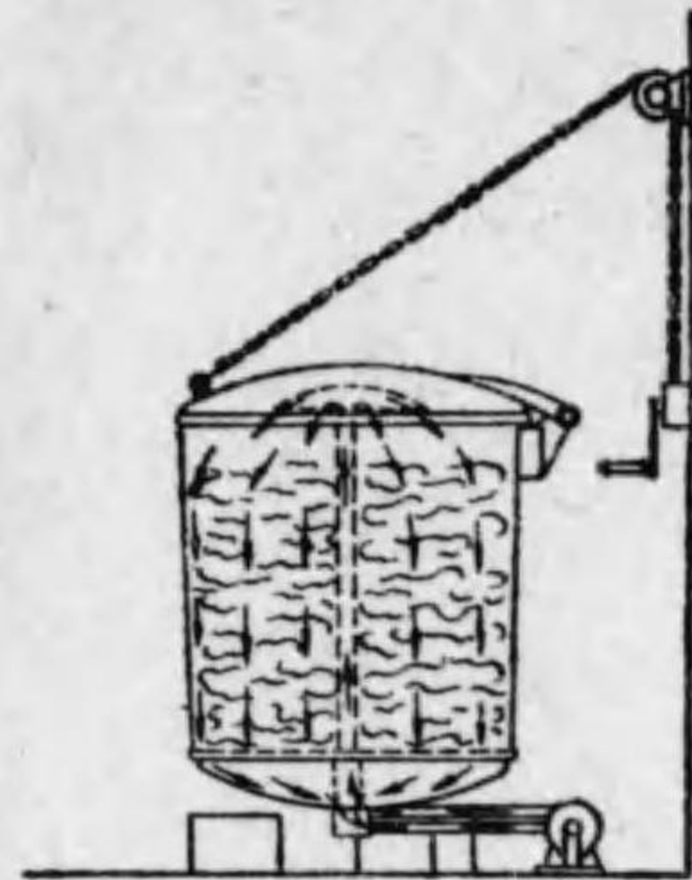
第3・1圖 高圧精練罐
