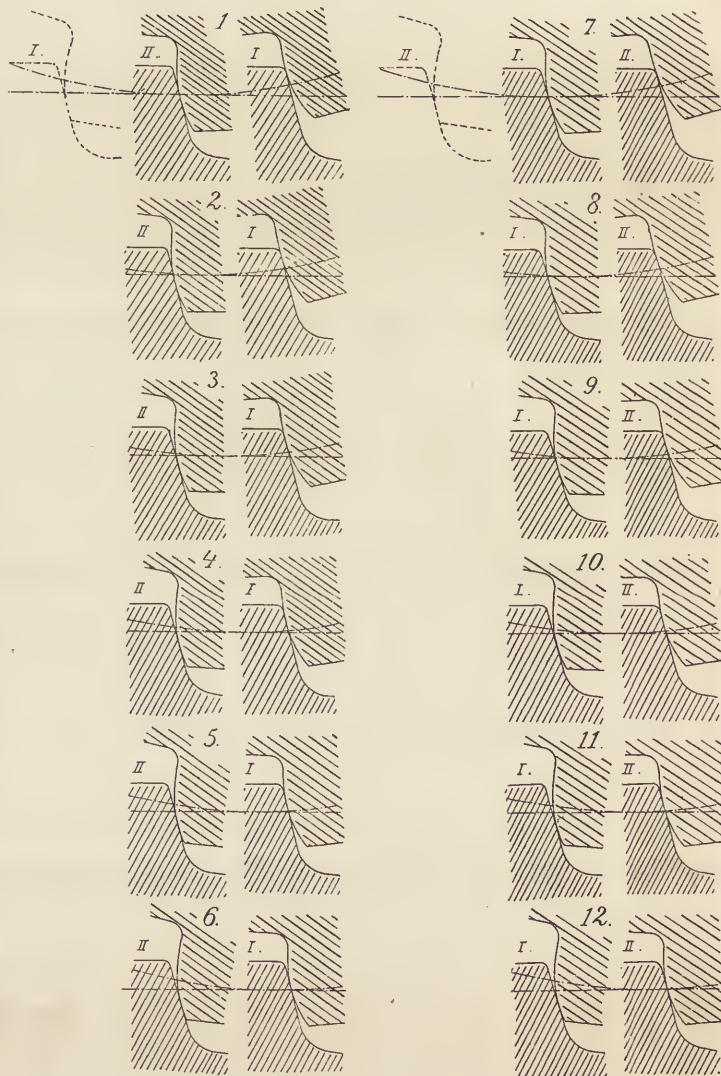
Gleichzeitige Eingriff-Stellungen des zweitheiligen Zahnrades in Distanzen von 10 mm.
