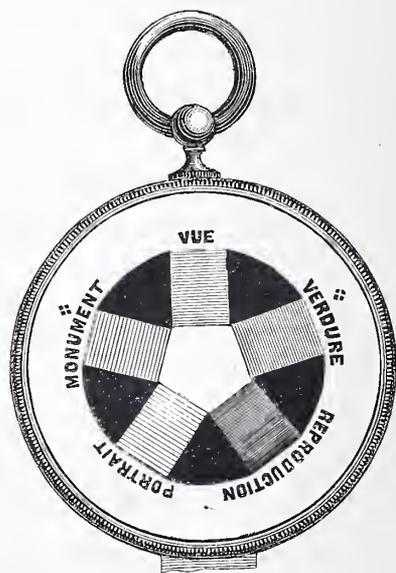
Photomètre de M. Deyrolle.
