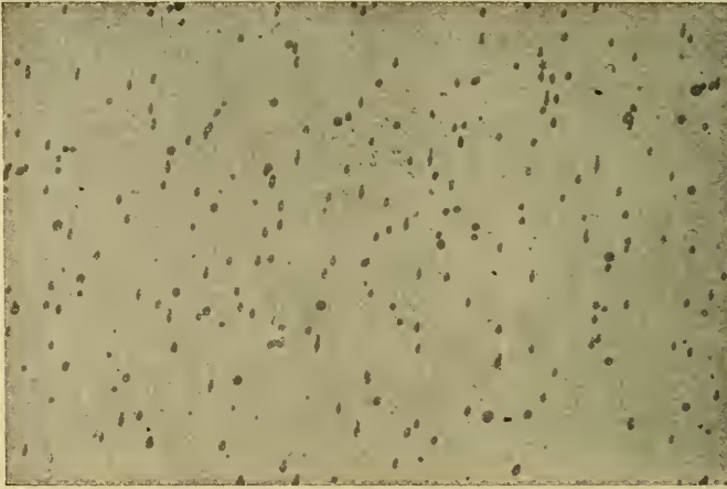
Fig. 4. Verteilung der Flüssigkeit durch den Schlitzhahnzerstäuber.
