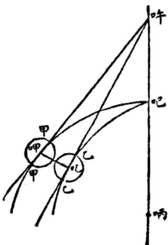
樞在半環或喫吧兩端之二孔內。半環中點喫繫以不能絞之絲線上繫活鉤。鉤於鋼架端之碼碯小杯內。造此器之工宜極精。必面阻力極小。且能真相定。乃使其圓板速旋轉。而任其自轉。板重而旋轉極速。則可久轉不停。而方向久不改。故可徵地球之自轉也。蓋其樞與掛點絕無面阻力。不能改其旋轉之平面。故轉軸吶叮之方向。可久不改。而久平行。假如在某時。吶叮軸指某恆星。若以地爲不自轉。而恆星繞地行動。則少頃之後。其星必已在軸所指之點之前。而軸與地之方向。則絕不改。若
