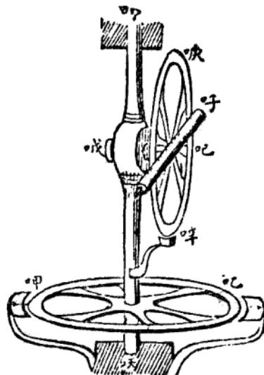
令與遠鏡內之交點合。察地平環上之度分。乃定鏡於垂環。俟此星過午後。轉器隨之。至星復與交點合。再察平環之度分。乃以二度分之較折半。即得地平之南北點。蓋前後所測二高度等。凡星在子午圈兩邊之高度等。則兩點距午之地平經度亦必等故也。此名等高度法。歷家恒用鐘表測二高點之時較折半。得午正。此法亦可正鐘表之差。
