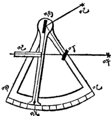
見丁透光回光鏡中星之二象合爲一。卽知其差數。蓋象合時。其度當爲○。若不爲○。所得度分卽蓋數。每測去其差數。卽得真度分焉。若回光鏡不正交儀面。則鏡傍有小螺旋可旋動正之。大率活半徑上之回光鏡。造儀者已詳細定之。無須正。惟叮鏡當正其差。而遠鏡之視軸。亦必詳審。令與儀面平行。其正差法用一地平線一垂線相交。而以儀面合地平之垂面。以遠鏡正對交線。移動活半徑。令地平線與回光之影相合。又轉小螺旋。令垂線與回光之影相合。視地平線仍與影合。卽正矣。
