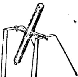
分。蓋若干時。有一定若干弧分過去也。其率一時十五度。若非赤道經。欲知其度分。須作銅環。細分度分秒以測之。如圖。呷咼叮爲銅環。分爲三百六十度。用天地人諸輻連於中心。心開圓孔。孔中鑲以短活軸。可旋轉。軸上裝一遠鏡。鏡之視軸呷咼與環面平行。而正交短軸。鏡之腰連一橫桿。桿正交視軸。短軸轉動。則鏡與桿循環而轉。假使欲知呷咼二物之距離。先令環合於呷咼及人目所居之面。而以法定環。令不動。乃轉鏡令視軸正射。復定鏡令不動。而視桿端小針所指察其度。或恰滿一度。但察其度。或在二度之間。須細察分秒。法詳後。復移鏡。令視軸正射呷咼。定鏡察其度。二度之較。卽環中心之角。呷咼之距離也。
