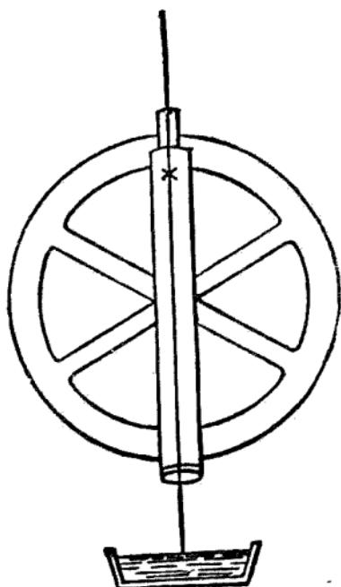
子午儀與牆環。皆所以測諸星過子午圈之時刻。測星過子午圈時刻。以正遠鏡方向最易。蓋星視道與鏡中交線之橫者平行。而用螺旋能細移至密合。少有未合。有餘暇改正。他處不能也。凡測角務得真確。若角有變者。則當於最大最小時測之。蓋此時不驟變。有餘暇可安徐細測也。星之高度亦然。其變之最大最小。皆在子午圈上。
