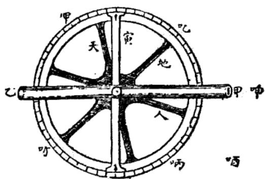
光點處。作正交二線用細螺旋轉之。如丁。先令交點與所察點之最近度合。乃轉螺旋。復令與所察點合。螺旋若干轉。即知距視軸所指點若干分秒。鏡力須極深。螺旋須極佳。此法能辨度分之極微。與遠鏡之細測相輔而行也。用此法測量全憑三事。甲乙筒向物須的準。一也。環之度分須極勻。二也。二分中間須細辨其秒微。三也。察筒之方向。甲乙兩端。或用交線。或開小穴。或一端用交線。一端開穴。俱可。皆全憑目力。若易以遠鏡。象鏡在乙。目鏡在甲。而於公聚光點置交線。則遠勝目力之細測也。
