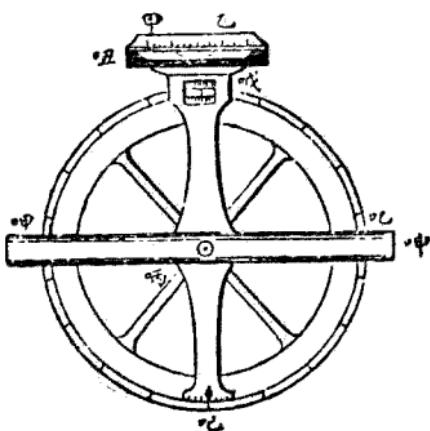
線在象鏡聚光點。令光線出鏡平行。復聚於他鏡之聚光點。與同方向天空之星無異鏡之倚度。卽星之高度。故測二線之交點。如測星焉。法置視軸準於環之兩邊。距環遠近不論。以環之鏡。二次窺之。俱令二鏡交線之點相合。則環上半之度。卽倍距頂點度。故天頂及地平點俱可知。準鏡二交線。一正交地平。一與地平平行。環鏡二交線。
