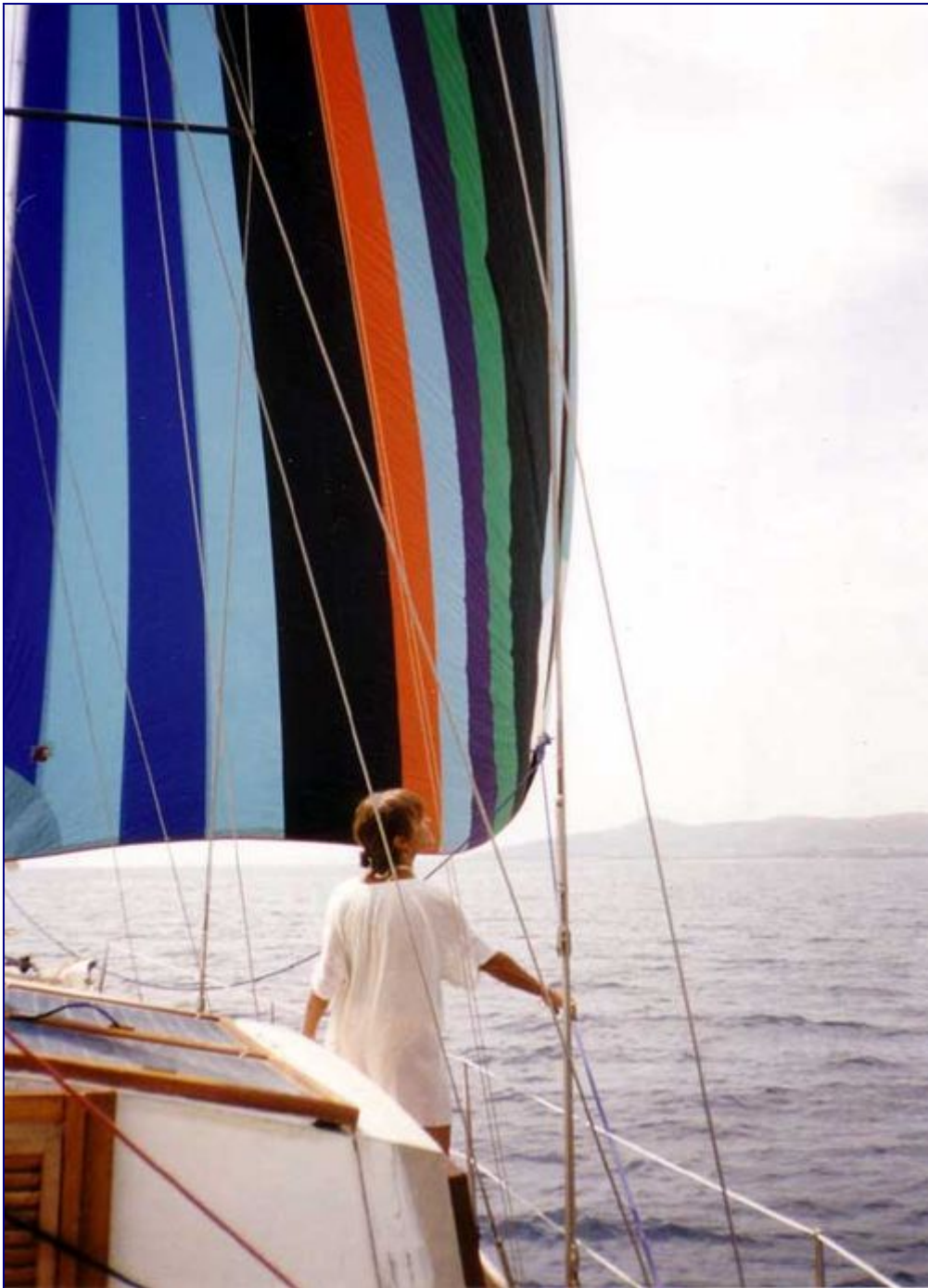
Génois léger double pli du prototype, 130 m 2 . Cette voile, sur cette photo, était endraillée sur l'étai. Elle est maintenant équipée d'un emmagasineur et pour l'utiliser il faut prolonger le beaupré par un bout-dehors.
