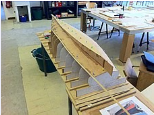
Placement et collage des œuvres vives.
