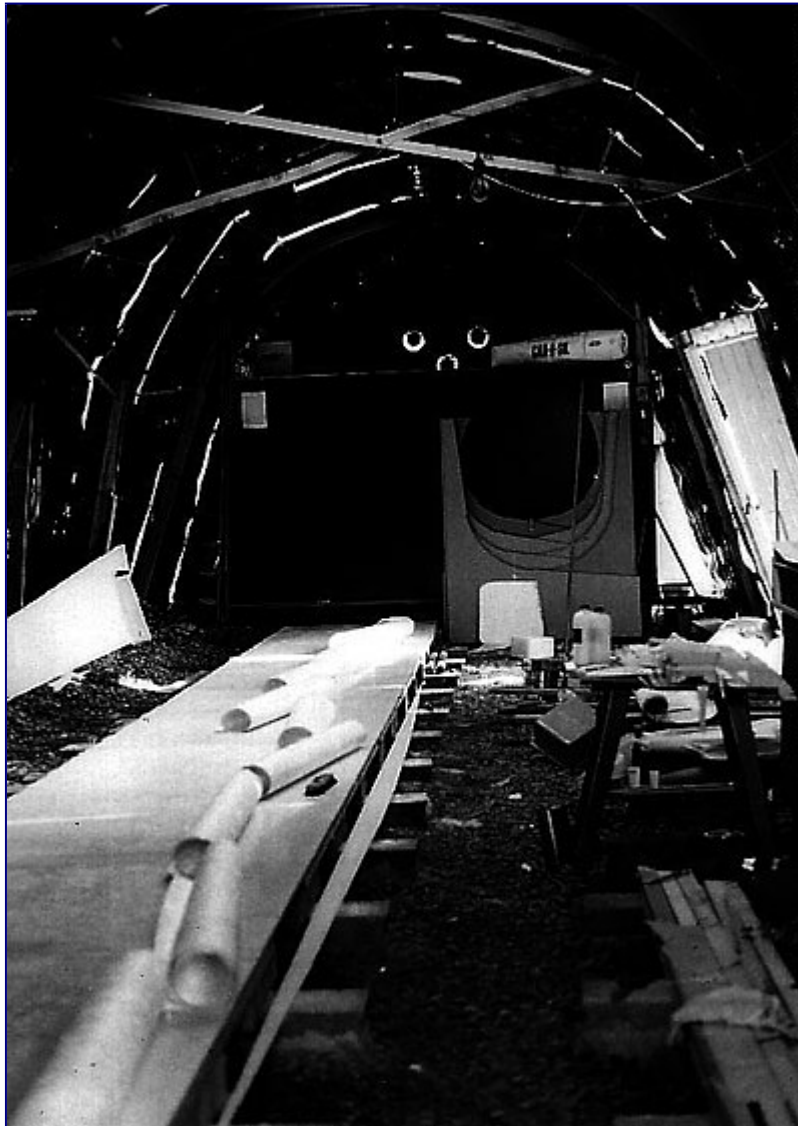
Plan de travail pour la stratification par plaques et, au fond, les gabarits sont rangés dans l'ordre de pose.
