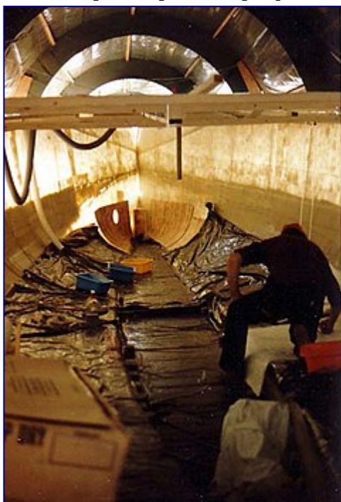
Pose du sandwich-balsa à l'étrave et préparation de l'orifice du premier propulseur d'étrave à turbine.
