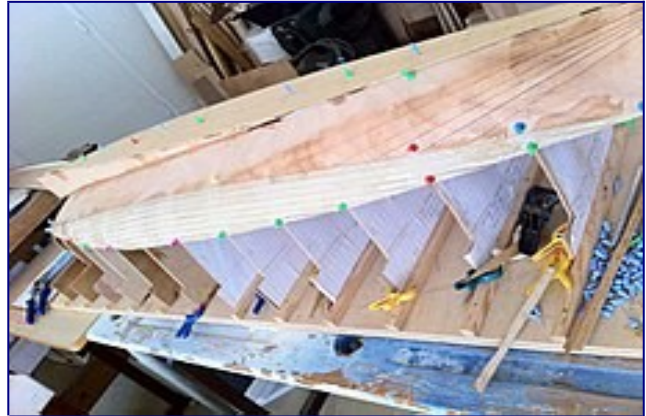
Découpe des baguettes pour le collage des œuvres mortes.
