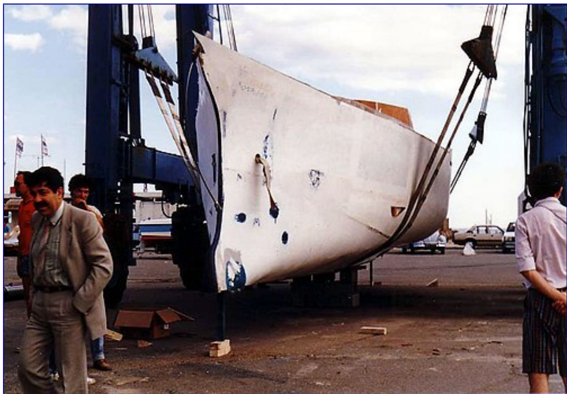
Pose sur poutres bois 300x300
