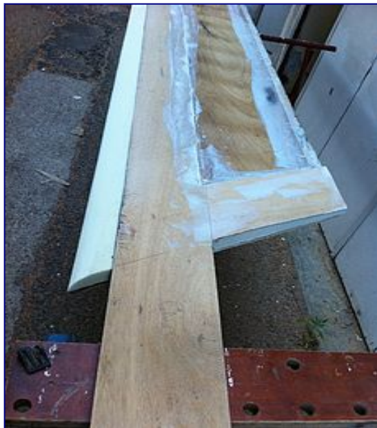
7. Mise en forme du bord d'attaque
