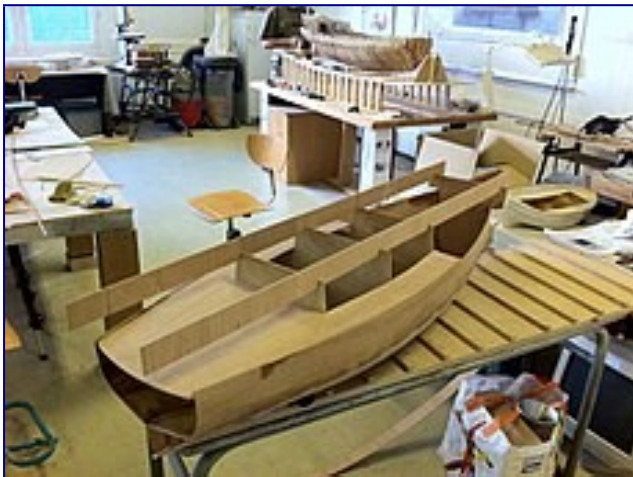
Positionnement des cloisons
