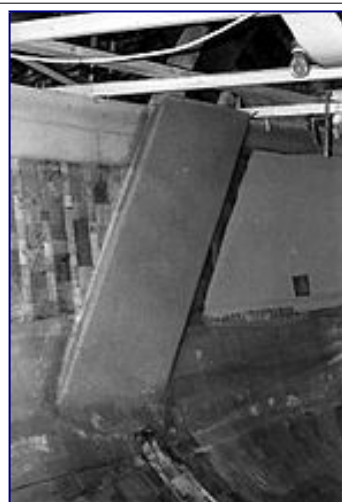
Stratification du puits de dérive bâbord
