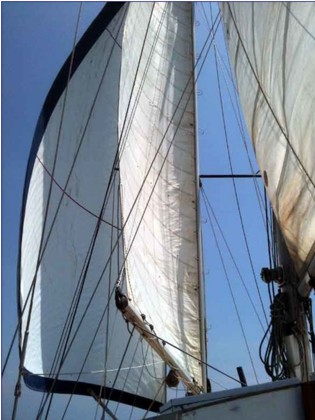
Voilerie modifiée en janvier 2004. Le yankee a été remplacé par un génois à enrouleur.
