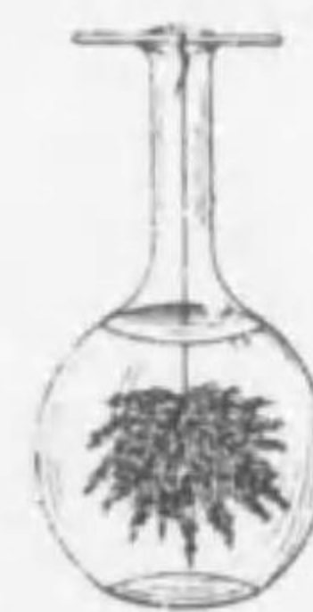
198. イオン化傾向の實驗 醋酸鉛の溶液に亜鉛片をつると鉛が析出する
