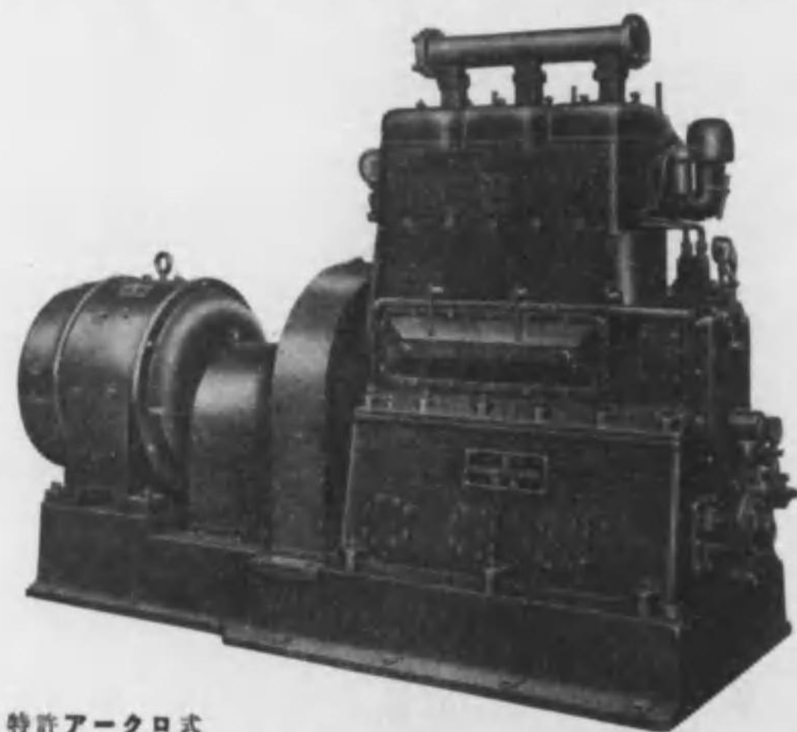
特許アークロ式 クボタ50馬力ディーゼル機関直結30.K.W.發電機
