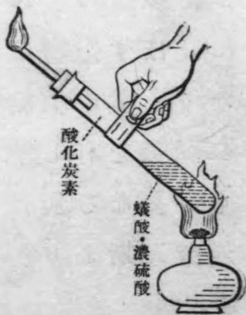
〔18〕 蟻酸と濃硫酸とより酸化炭素を發生せしむ。
