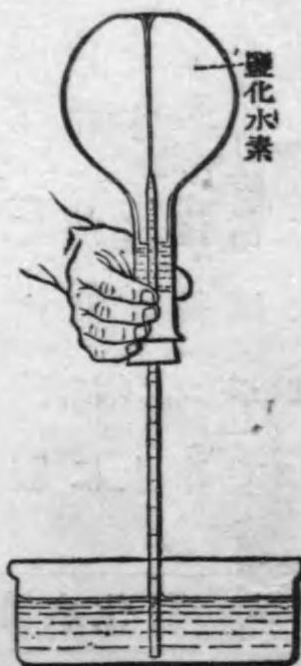
〔23〕 鹽化水素の水に溶くるがために見しるる噴水。
