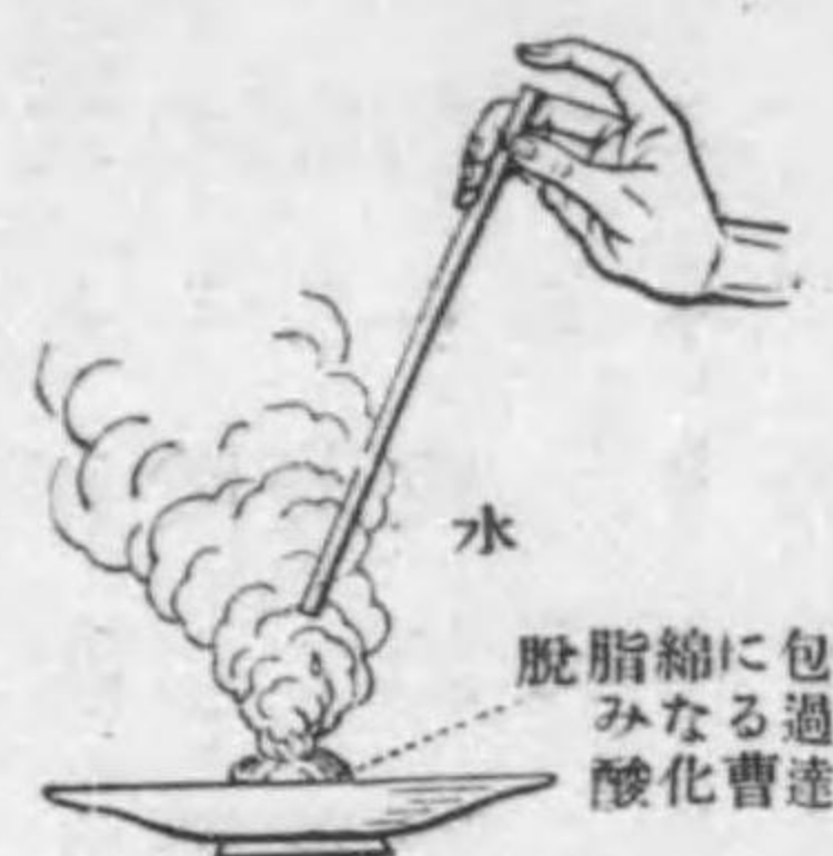
[57] 燃え易き有機物(例へば脱脂綿)に包みたる過酸化曹達に水を滴下して發火せしむ。
