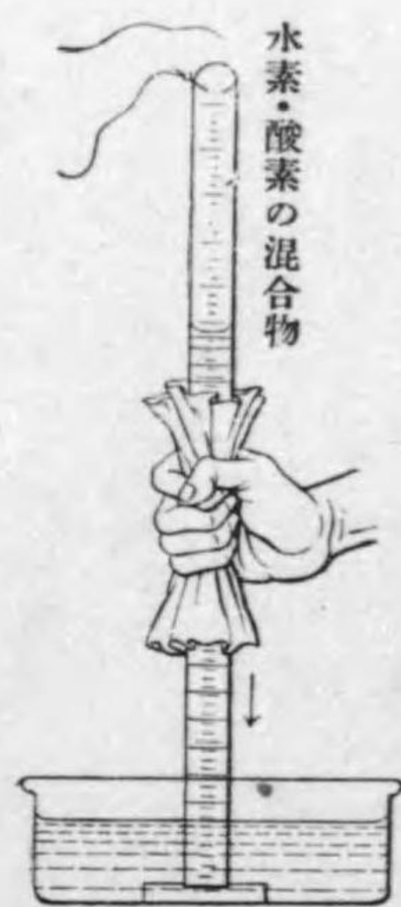
〔6〕 水素酸素の混合物に電氣装置によりて點火す。
