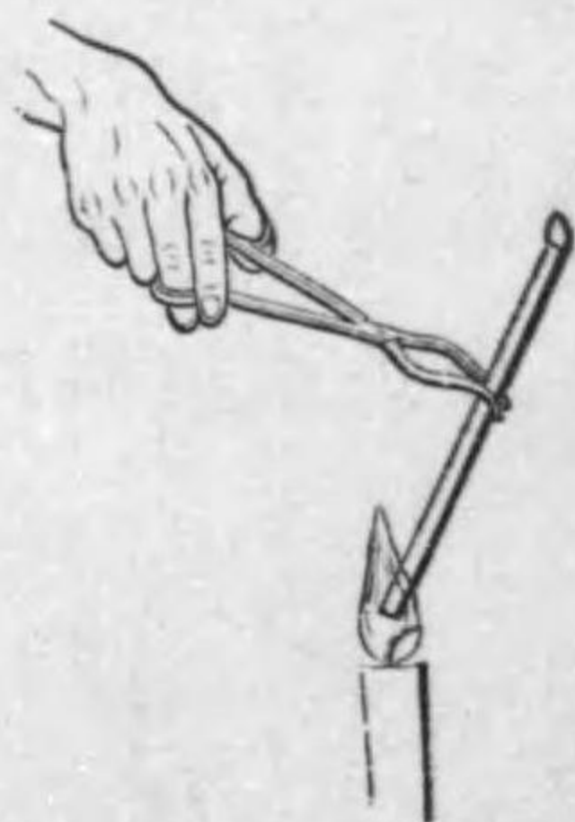
[12] 焰の内部に可燃性の瓦斯體の存在するを示す。(硝子管は熱したるを用ふるを可とす。)
