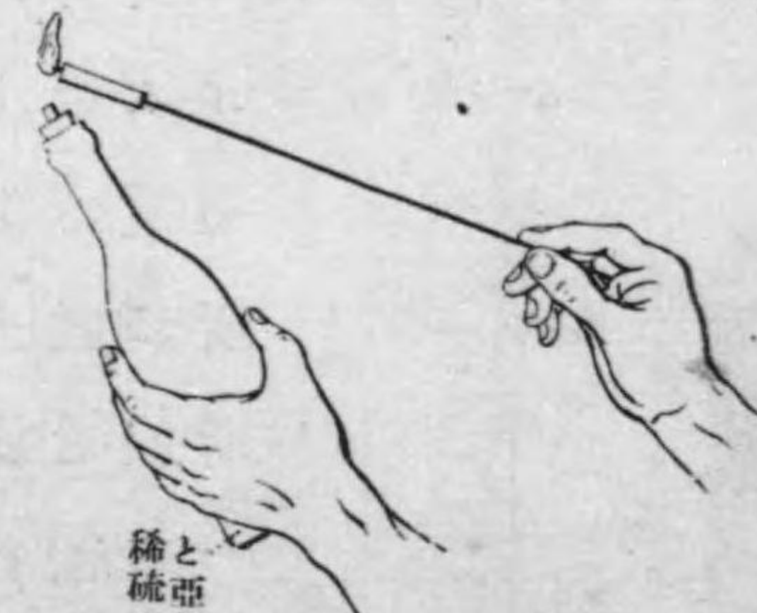
〔5〕 サイダーの罐に少許の亜鉛を入れ稀硫酸を注ぎ、間もなく之に點火して水素爆發の實驗を行ふ。
