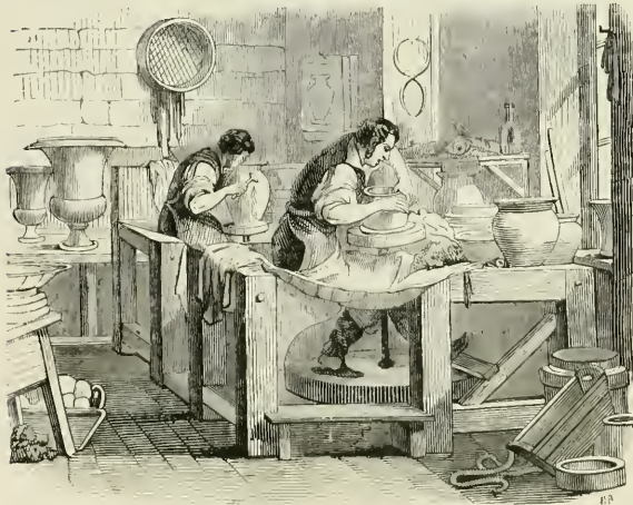
(Manufacture royale de Sèvres. — Tournours : ébauchage et tournassage.)
