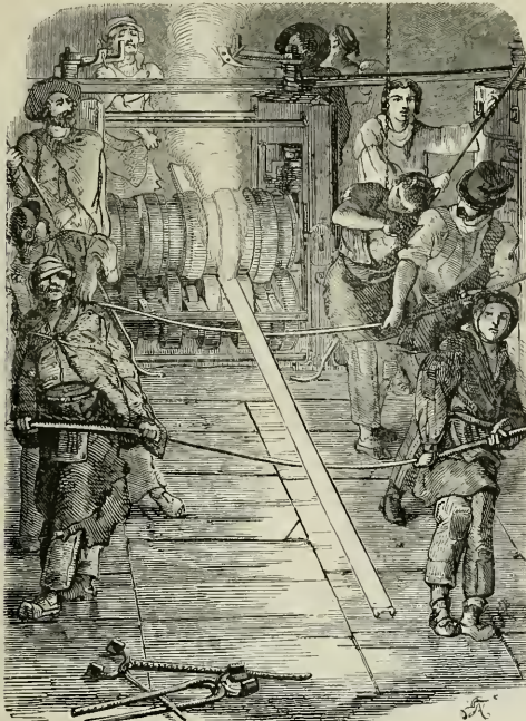
(Forges de Fourchambault. — Laminage d'un rail.)
