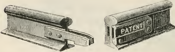
Fig. 869. Lehmann's patent. Laschenverbindung.
