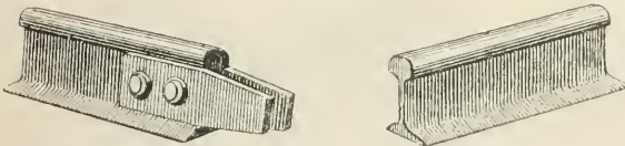
Fig. 866. Stoßverbindung mit Laschen ohne Bolzen.
