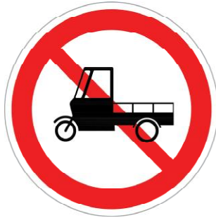
图 29 禁止三轮汽车、低速货车驶入(禁 12)
