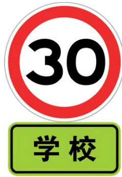
图 65 学校区限制速度标志设置示例
