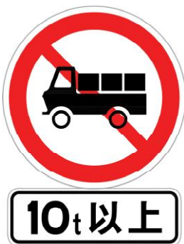
a) 禁止一定吨位的载货汽车驶入示例
