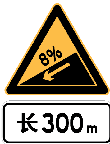
图 150 陡坡标志加坡度值及辅助标志示例
