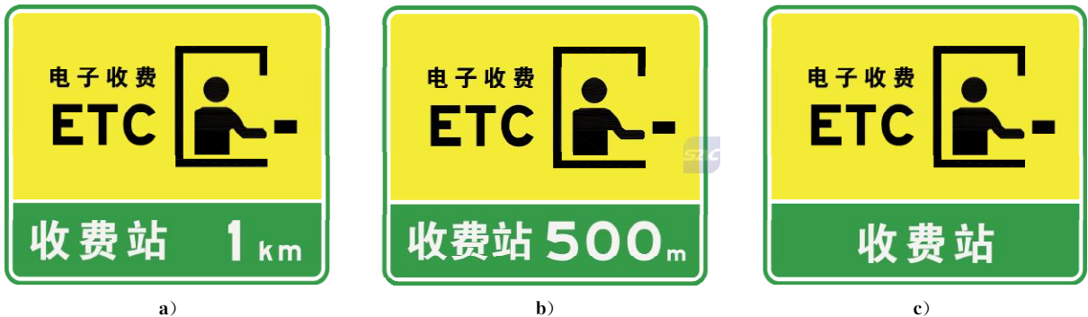
图 294 设有电子不停车收费(ETC)车道的收费站预告及收费站标志(路 70)
