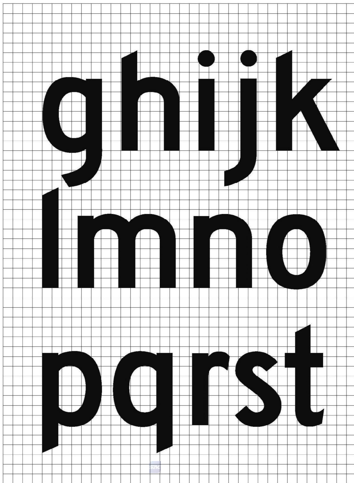
图 B.4 B 型交通标志字体字母和阿拉伯数字示例（续）
