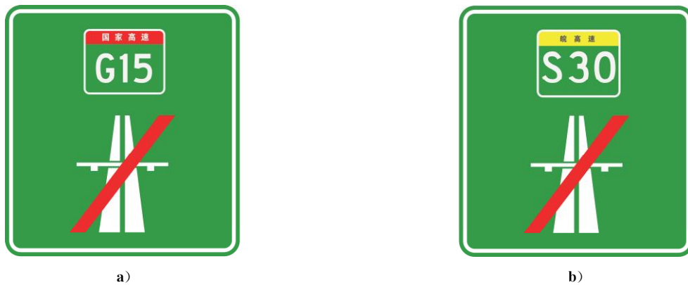
图 282 国家高速公路、省级高速公路终点(路 59)
