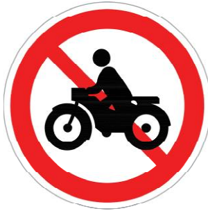
图 30 禁止摩托车驶入(禁 13)
