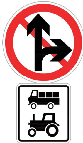
图 50 禁止直行和向右转弯标志加辅助标志示例
