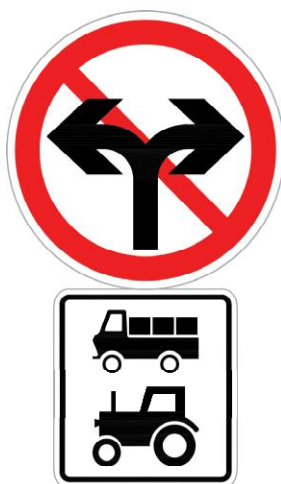
图 47 禁止向左和向右转弯标志加辅助标志示例
