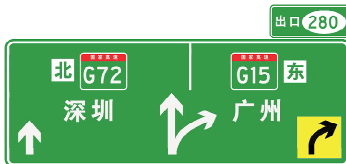
c) 出口匝道为 2 条车道枢纽式互通立体交叉的出口方向(路 51)
