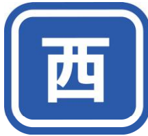
图 241 设置在指路标志版面外的方向标志(路 27)
