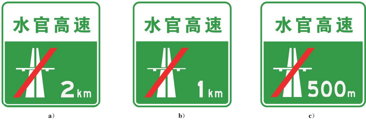
图 281 无编号的高速公路或城市快速路终点预告(路 58)
