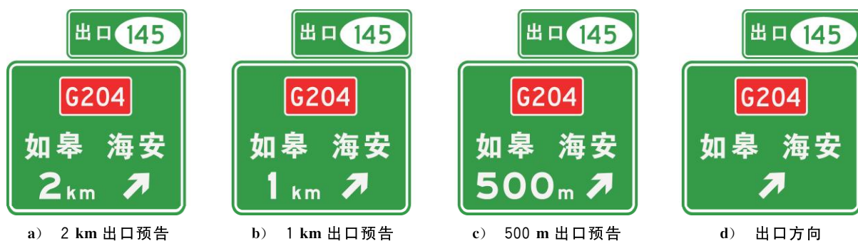
图 264 一般互通式立体交叉出口后道路有编号的出口预告(路 42)及出口方向(路 43)
