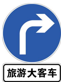
图 81 向右转弯标志加辅助标志示例
