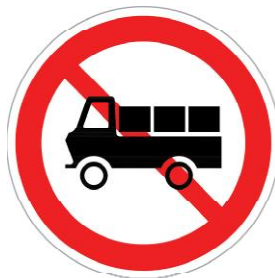
图24 禁止载货汽车驶入(禁9)
