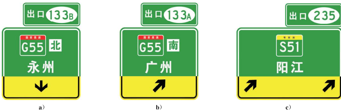
图 270 直出车道出口方向(路 48)
