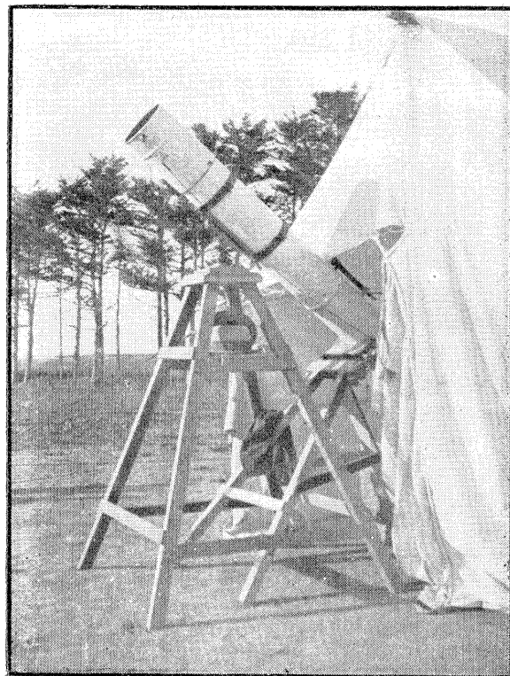
第四圖 北海道我國隊之主要儀器 德國蔡司公司特製之一六零公厘鏡
