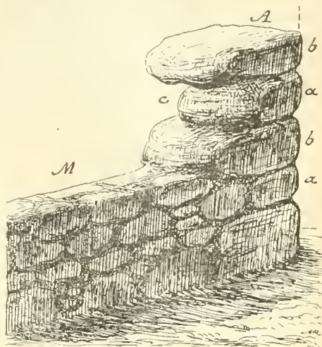
Fig. 43. — Mur et encadrement en moellons.
