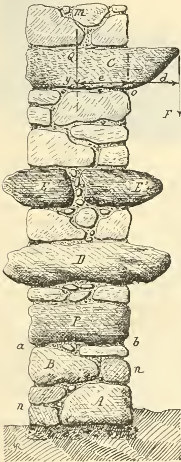
Fig. 40. — Coupe verticale d'un mur en moellons.
