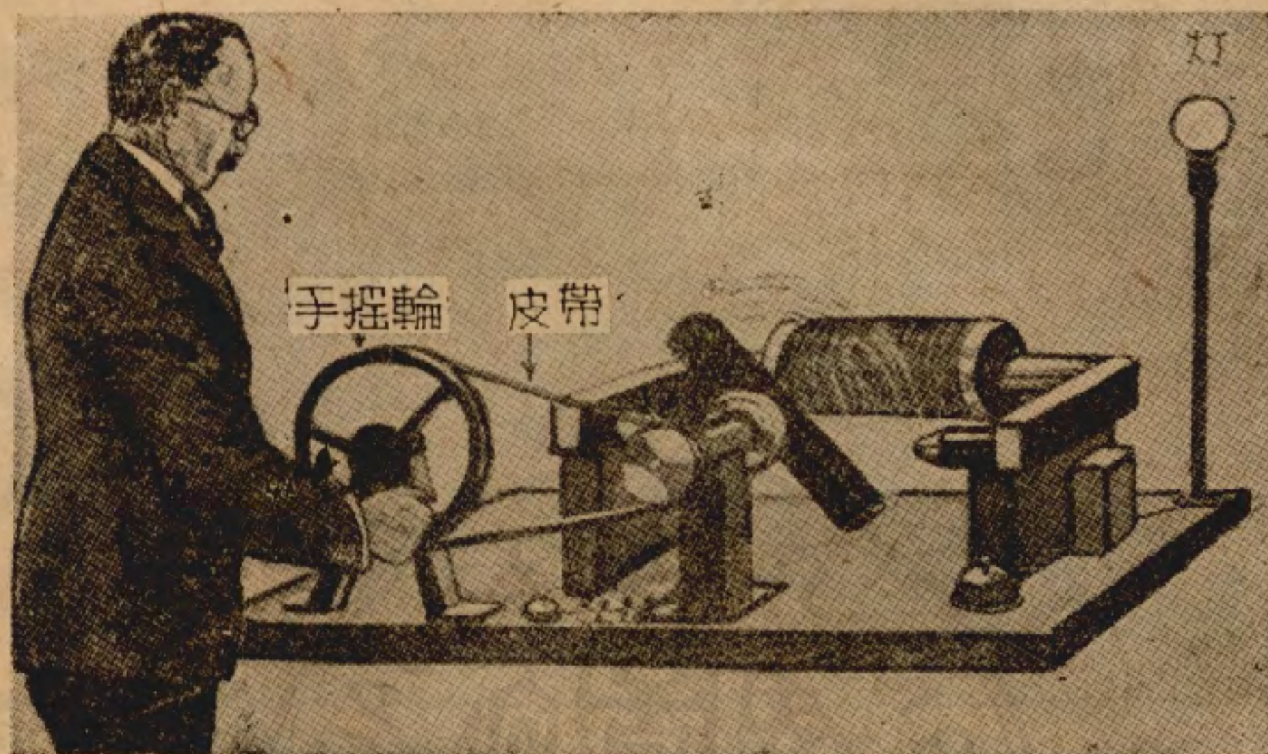
圖十 從這個起點，就逐步發生了現代的龐大發電機。在這只電動機上，加上一個手搖輪和皮帶使它急速轉動，它就發生電流足以點亮旁邊一盞小電燈。
