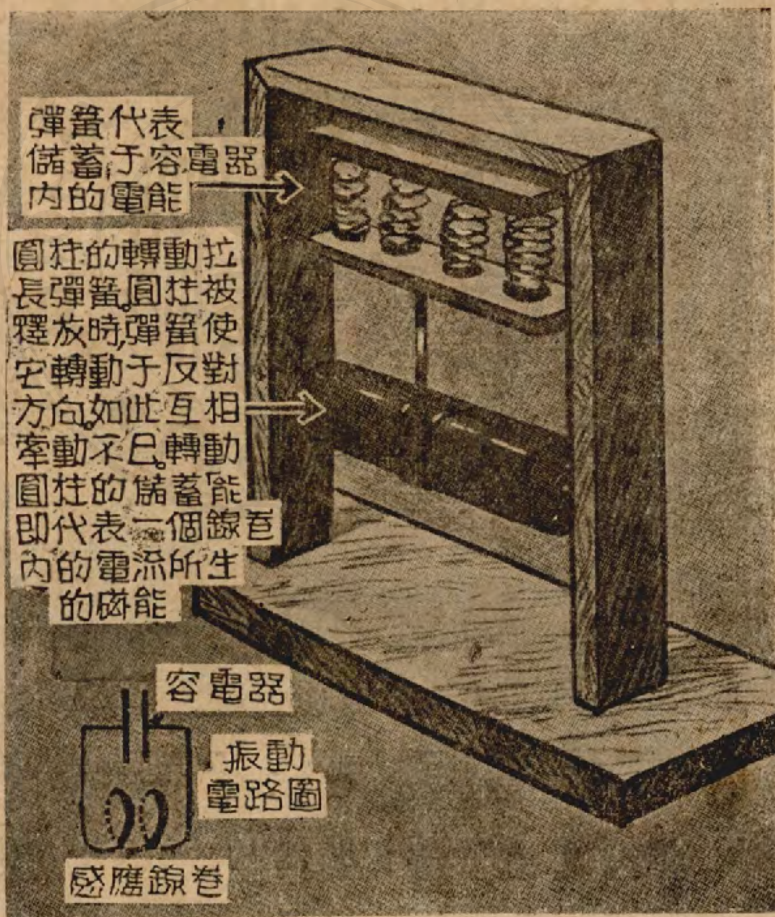
圖二 說明振動電路的一個簡單模型:在一個電路中(圖左下角),容電器的放電被導入一個線卷,並維持線卷中的電流流動,因此將容電器起電於反對之方向。
