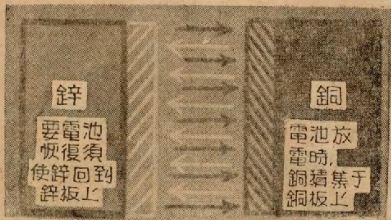
圖十 (3)電子從鋅版流到銅版,使電池漸漸衰竭;欲使電池恢復原狀,必須把電子趕回。
