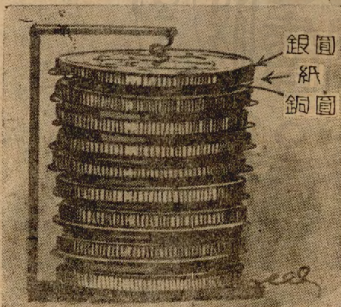
圖三 伏打的簡單電池可用錢幣（銀和銅），間以鹽溶液中浸過的紙來構成。頂上一枚錢幣已被起電，可用一只驗電器來顯示，儘管把它一次一次放電，它總是帶電的。
