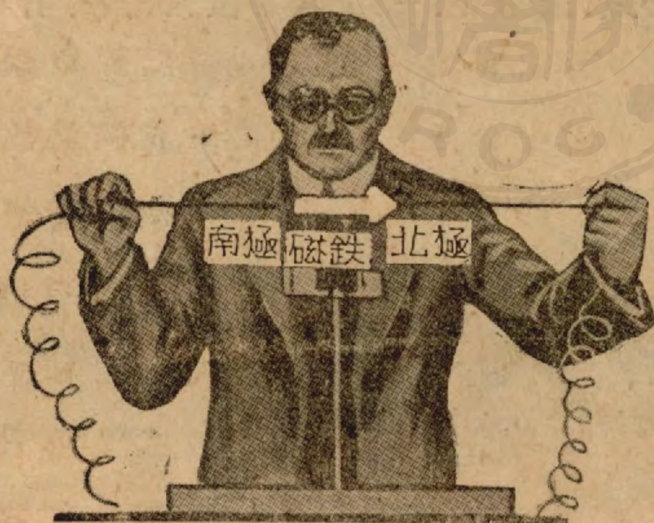
圖二 一個電流所生的磁場，因此引起電磁鐵的發明。這個實驗表示流過一根線的電流施力于一個磁鐵上而使它偏轉。
