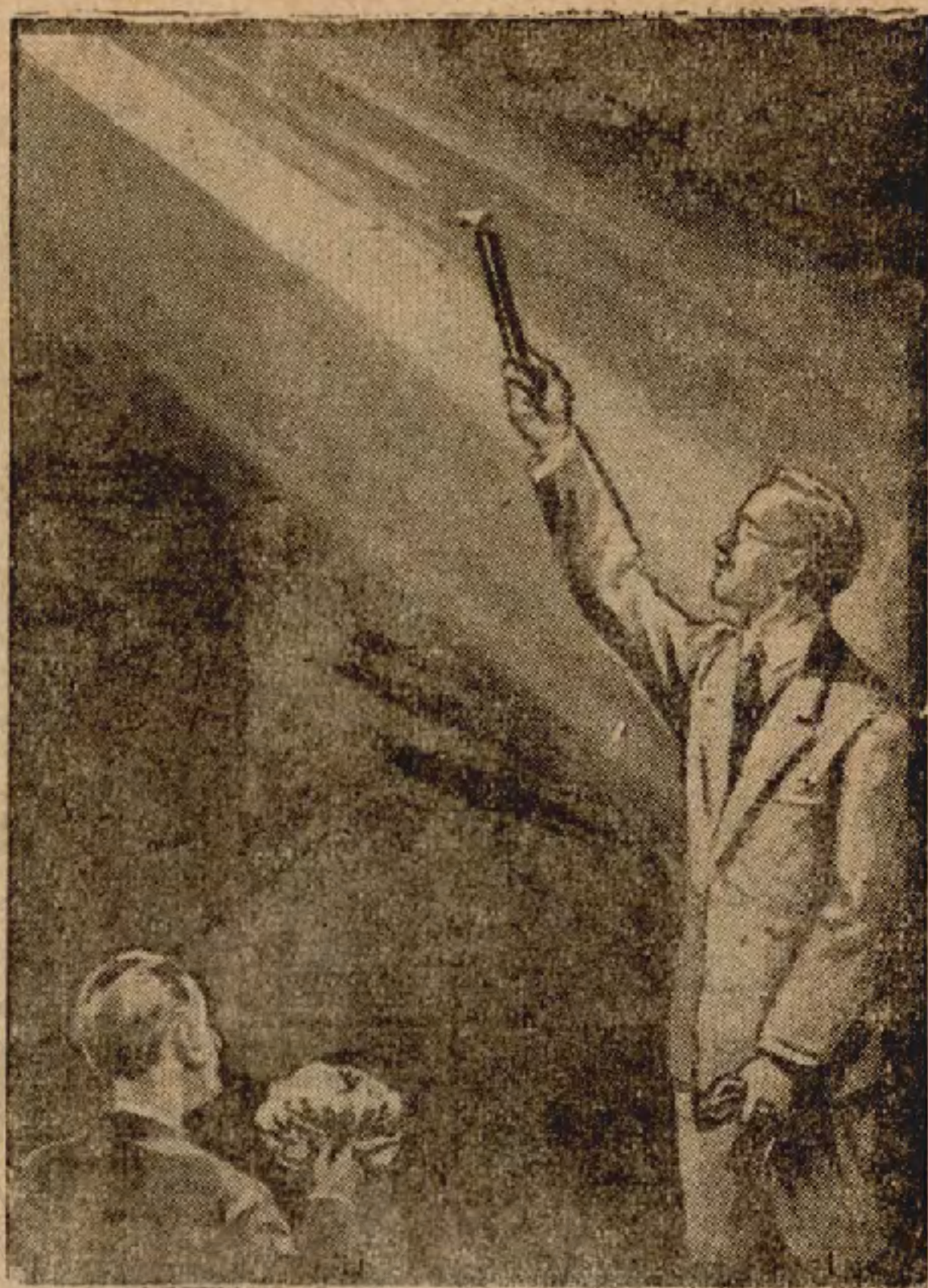
圖八 這只鋁箔製的蝴蝶飛到帶電的棒上，因此帶着和棒上同類電荷。倘使那蝴蝶停到一朵紙花（非導體）上，就被吸引，但倘使停到一個人的手（導體）上，就被推斥。
