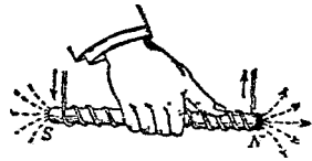
圖 319 運送電流之線圈，決定其極性之定則。
