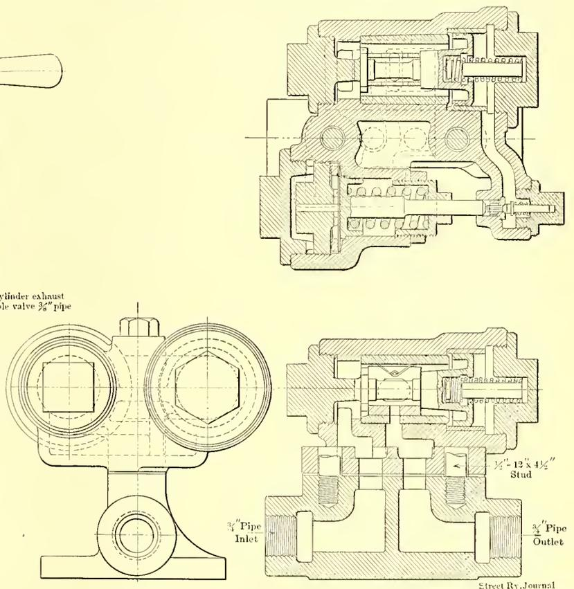
FIG. 5.—DETAILS OF REDUCING VALVE FOR SURFACE TRACTION AIR BRAKE SYSTEM
