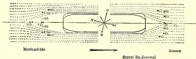
FIG. 18.—DISTRIBUTION OF AIR PRESSURES AROUND CAR
