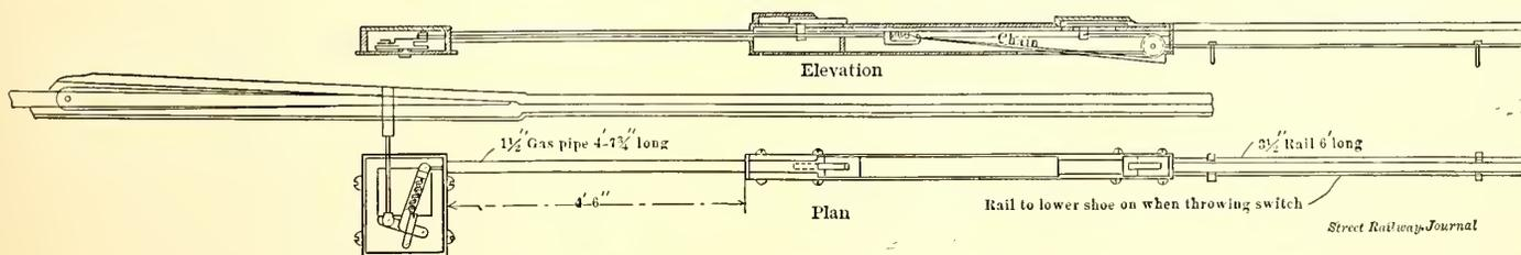
TRACK ARRANGEMENT REQUIRED FOR AUTOMATIC SWITCH
