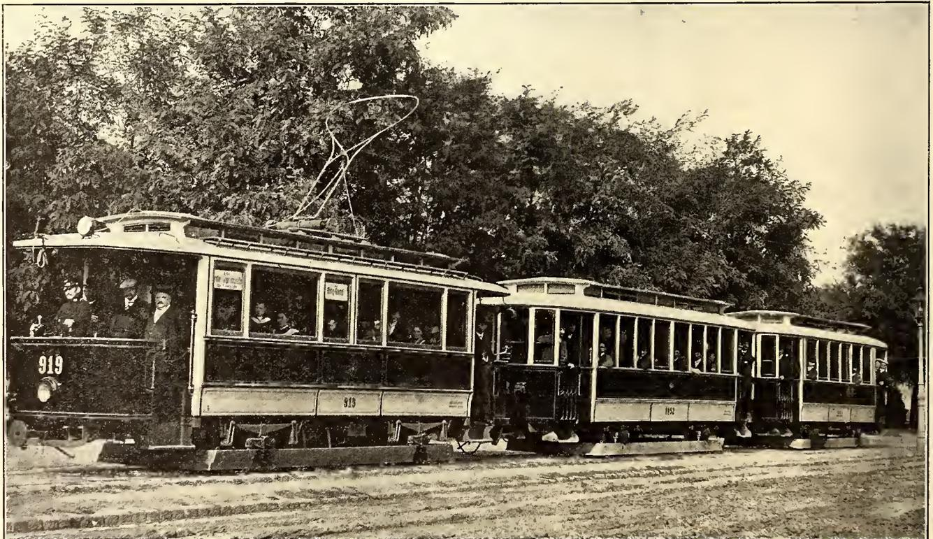
VIEW SHOWING STANDARD TRAIN ON THE VIENNA TRAMWAY SYSTEM DURING THE RUSH HOURS, CONSISTING OF ONE MOTOR CAR AND TWO TRAILERS
