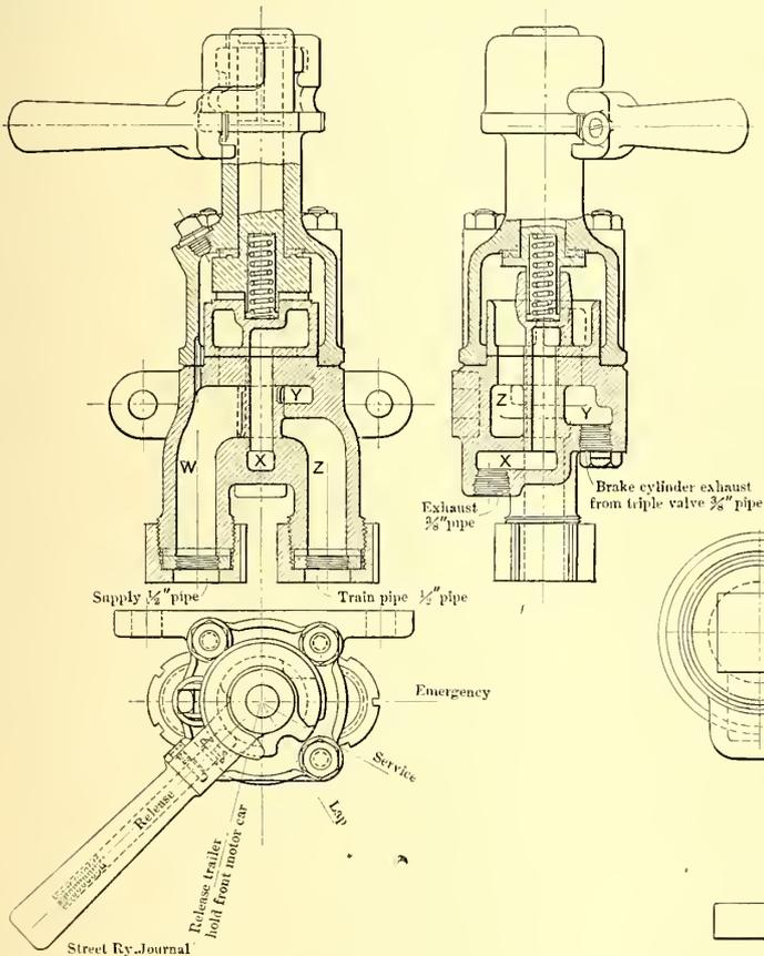
FIG. 4.—DETAILS OF CONTROLLING OR BRAKE VALVE
