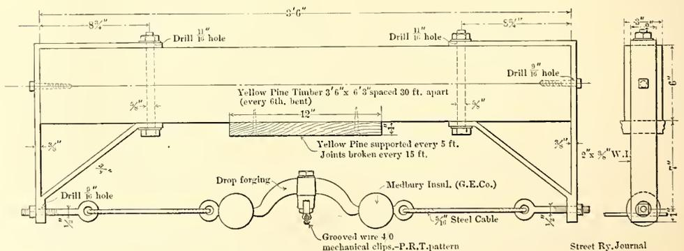
FIG. 6.—ENLARGED DIAGRAM SHOWING FLEXIBLE HANGER ON LOCAL TRACKS
