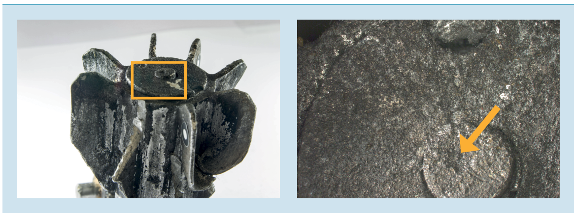
Figuur 9: Indeuking van het slaghoedje van de grondkardoes in het staartstuk van de mortiergranaat (links), met een microscopische uitvergroting van het slaghoedje (rechts). (Foto: TNO)
