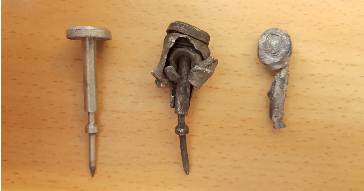
Figuur 12: Verschillende slagpinen: links een ongebruikte slagpin, in het midden een slagpin uit de test in gewapende stand en rechts de slagpin uit het ongeval. (Foto: TNO)
