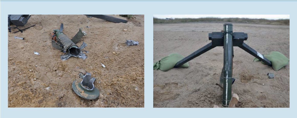
Figuur 8: Schietbuis na een inwendige detonatie (links) en deflagratie (rechts) van een 60 mm mortiergranaat op basis van referentieproeven KCW&M. (Foto's: KCW&M)
