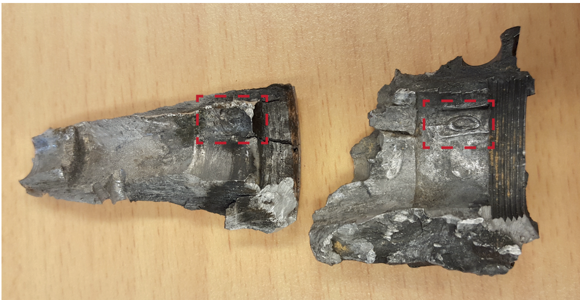
Figuur 10: Afdruk van de sluiser en sluiserveer op de binnenwand van de geteste schokbuis in de gewapende stand (links) en op de binnenwand van de schokbuis van de ongevalsgranaat (rechts). (Foto's: TNO)
