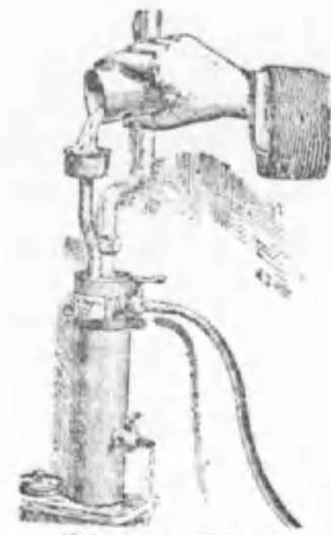
検水コックを開きて 水を補給する状態
