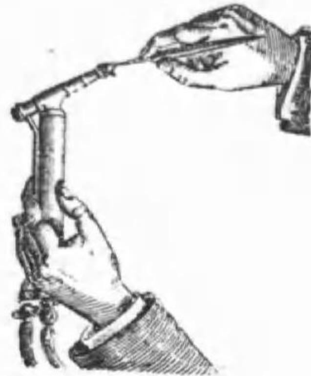
火口の掃除には銅、眞鍮等の針金を用ひる事
