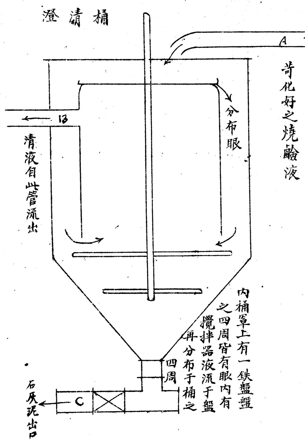
積於桶底。可由C管用吸筒送至混泥桶。加水清洗。在混和桶混和後。順流至洗泥桶。再澄
