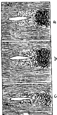
單翼模型之第五種裝置情形係有翼縫者結果甚佳。 a. 剎車直接附着于翼面者。b. 第五種裝置情形係有 附圖八 在環形揚風洞中試驗所得之衝刺車效應。
