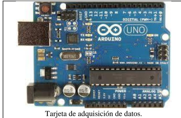
Tarjeta de adquisición de datos.
