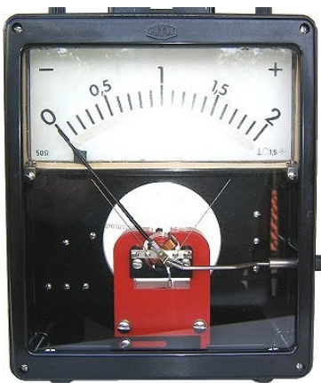
Fig. 135: Ampermezurilo kun turniĝanta bobeno
