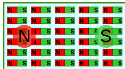
Fig. 88: elementaj magnetoj ordigitaj per ekstera magneto
