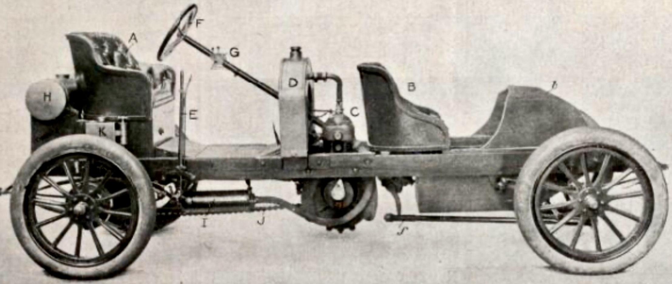
VOITURETTE GALLIOT A 2 PLACES EN TANDEM (*type monocylindrique*). — A, B, sièges. — C, moteur à circulation d'eau. — D,
