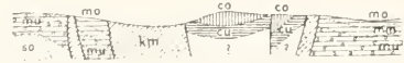
Fig. 39. Gräben und Horst: Die mit mo bezeichnete Scholle links ist ein Horst, die schmale Scholle links daneben ein Graben, die Schollen co, co sind Gräben (Profil durch die Kreidegräben im Triasgebiet östlich des Eggegebirges bei Neuenheerse, so oberer Buntsandstein, mu, mm, von unterer, mittlerer, oberer Muschelkalk, km mittlerer Keuper, cu, co untere, obere Kreide). Nach Stille.
