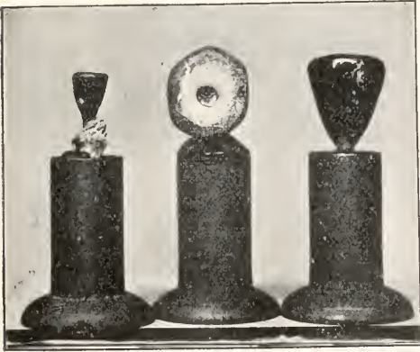
Fig. 5. Schmelztropfen von synthetischem Rubin. Der mittlere besitzt Kristallform, hexagonales Prisma.
