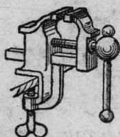
圖 47 機師之虎頭鉗。 螺旋係用槓桿轉動之。
