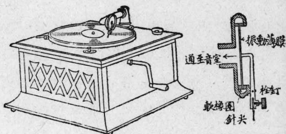
圖 465 盤式留聲機及其膜與針之剖面圖。
