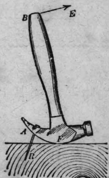
圖 24 鷹爪錘作用如曲槓桿之情形。
