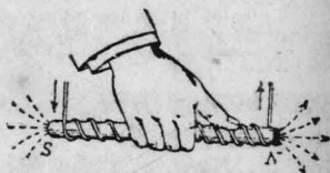
圖 319 運送電流之線圈，決定其極性之定則。
