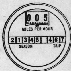
圖 166 汽車速度計，指示速度及車行之哩數。
