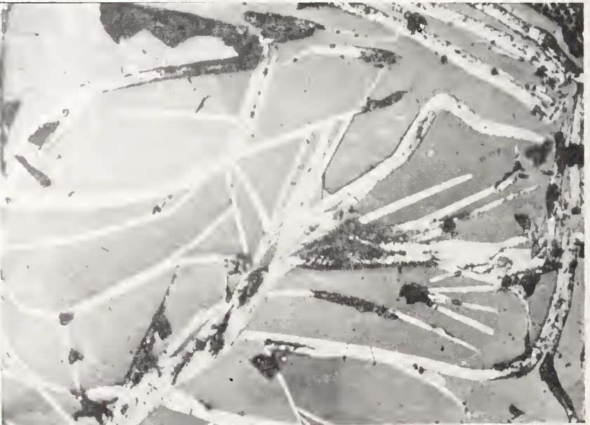
4. ábra. Plasztikusan deformált molibdenitpikkelyek kalcitos meddőben. Ércsiszolat, // N, 400× Fig. 4. Molybdenite flakes affected by plastic deformation in a calcite gangue. Polished section
