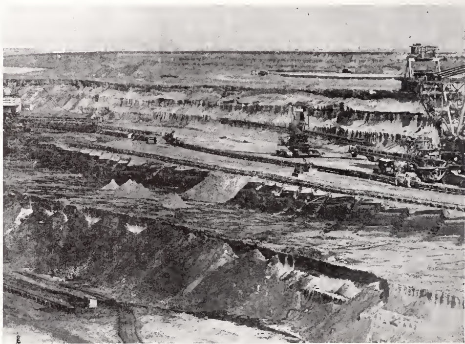
2. ábra. A visontai külfejtés kotrási rézsű rendszere Fig. 2. Bagger slope system of the Visonta open pit mine
