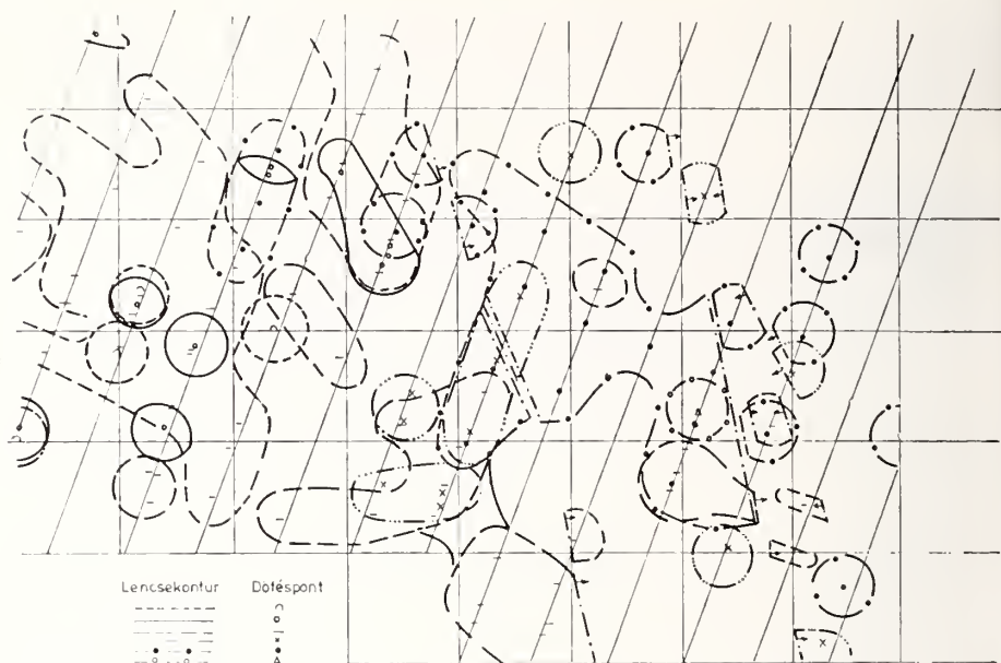
2. ábra. Bányabeli kutatás alapján szerkesztett összesített ércestekontúr-térkép Fig. 2. Cumulative contour map of ore bodies compiled on the basis of underground explorations
