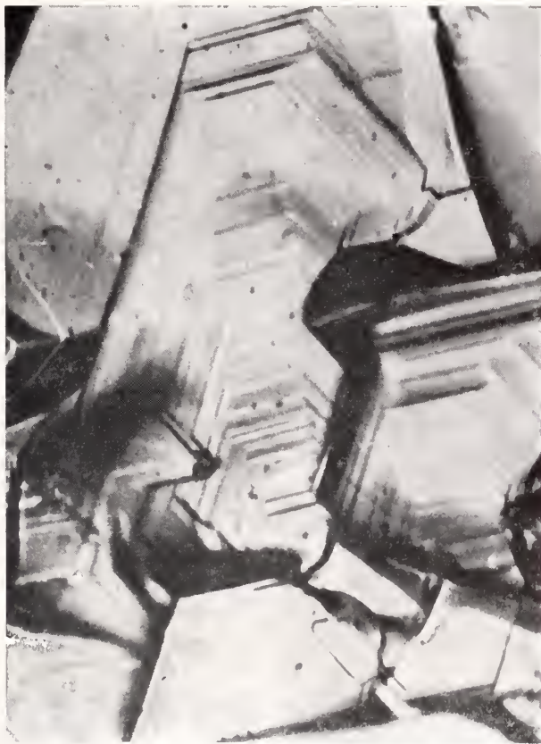
5. ábra. Molibdenit növekedési struktúra a 0001 lapon. // N, 400×
