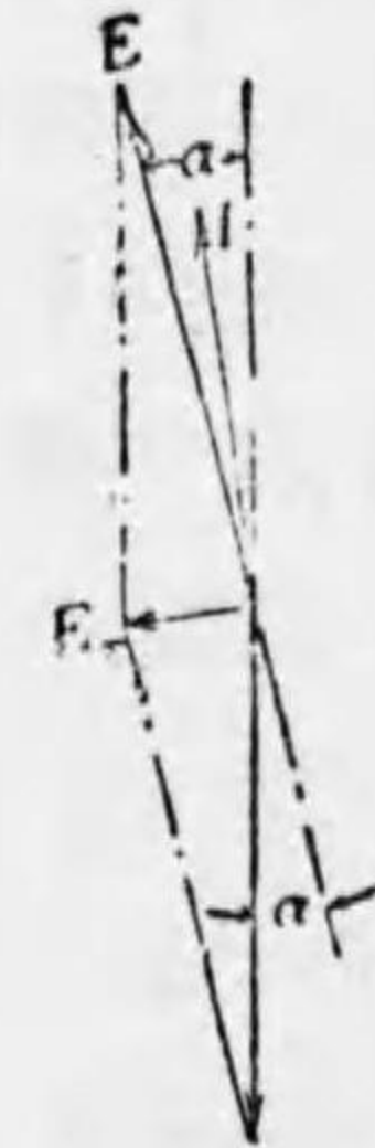
大きな機械と並列に接続した小さい機械に對する「ベクトル」線圖
