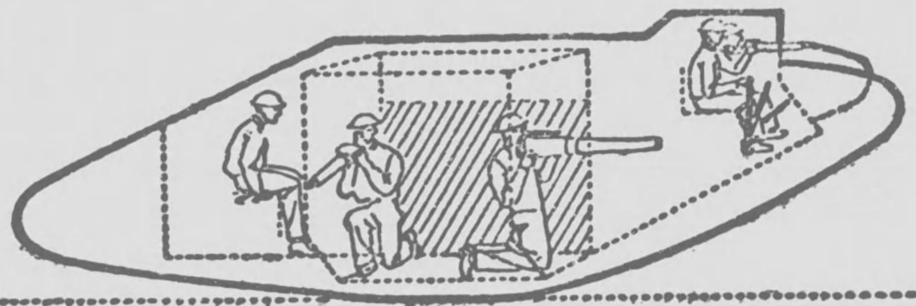
マークIV型戦車の断面 左より右に 變速機手、 ルイス機関銃手(五十七耗砲の二番砲手を兼ね、五十七耗砲手、運轉手、戦車長(ルイス機関銃を持つ)、點線の四角は張出砲塔、斜線は發動機の位置を示す
