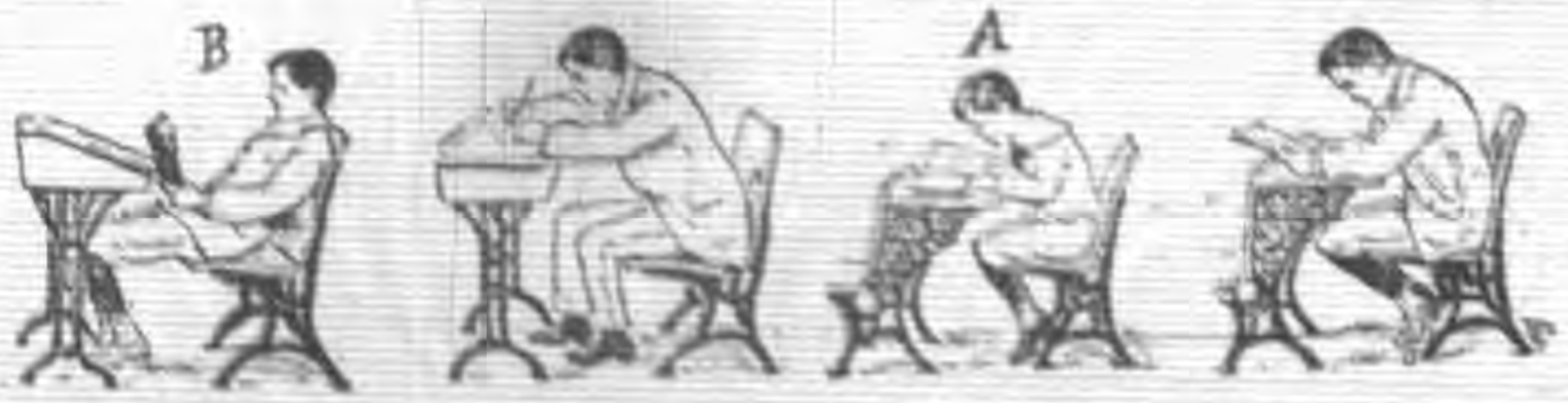
課桌過高過低及距離過遠之狀 桌椅相距過遠不便作事之狀
