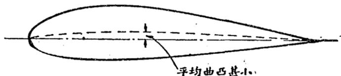
圖 145. 厚度大而平均曲凸小之翼剖面
