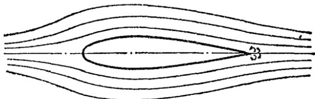
圖 17. 流線體在普通流體中之情形
