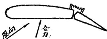
在大仰角時合力近前端故襟翼上之壓力薄弱遂任許彈簧將襟翼推下
