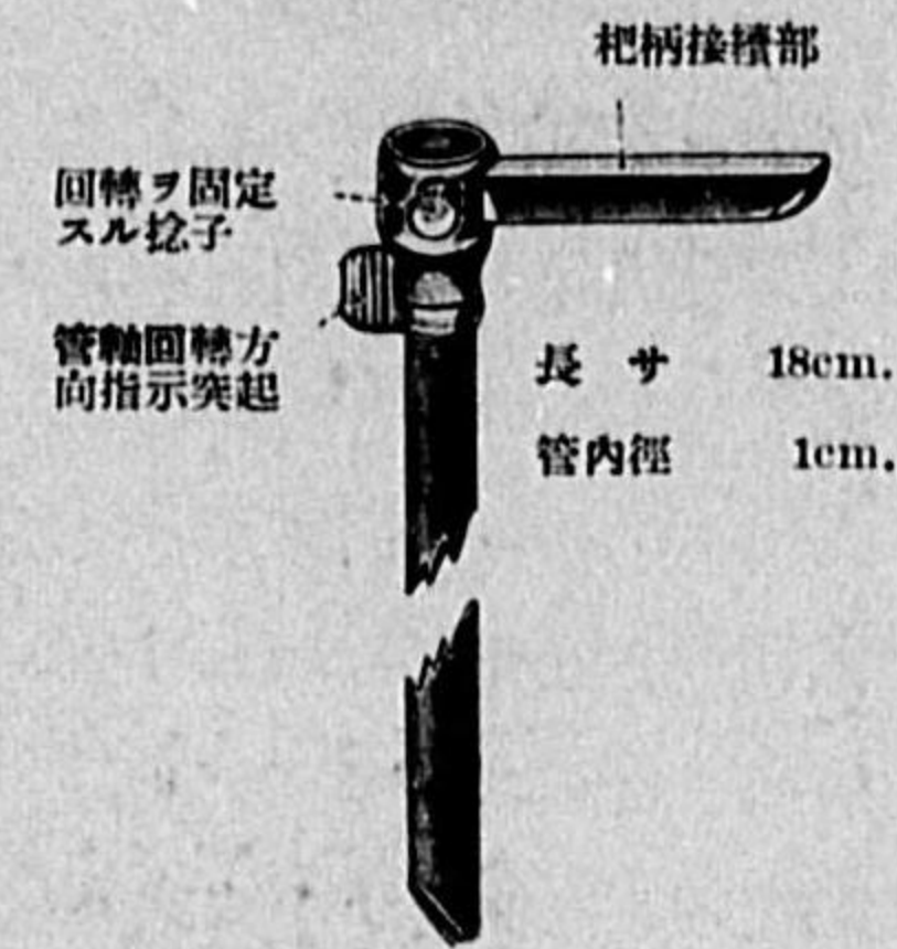
第二百七圖 自家改良回轉管狀鏡
