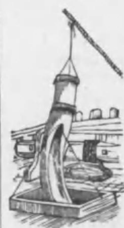
船中ノ下室ニ空氣ヲ開達セ ンガ爲ニ帆布ヲ以テ製シタル 筒形ノ者ナリ
