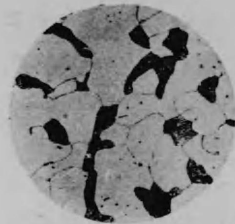
第三十圖……炭素0.2%を含有せる鋼(160倍)
