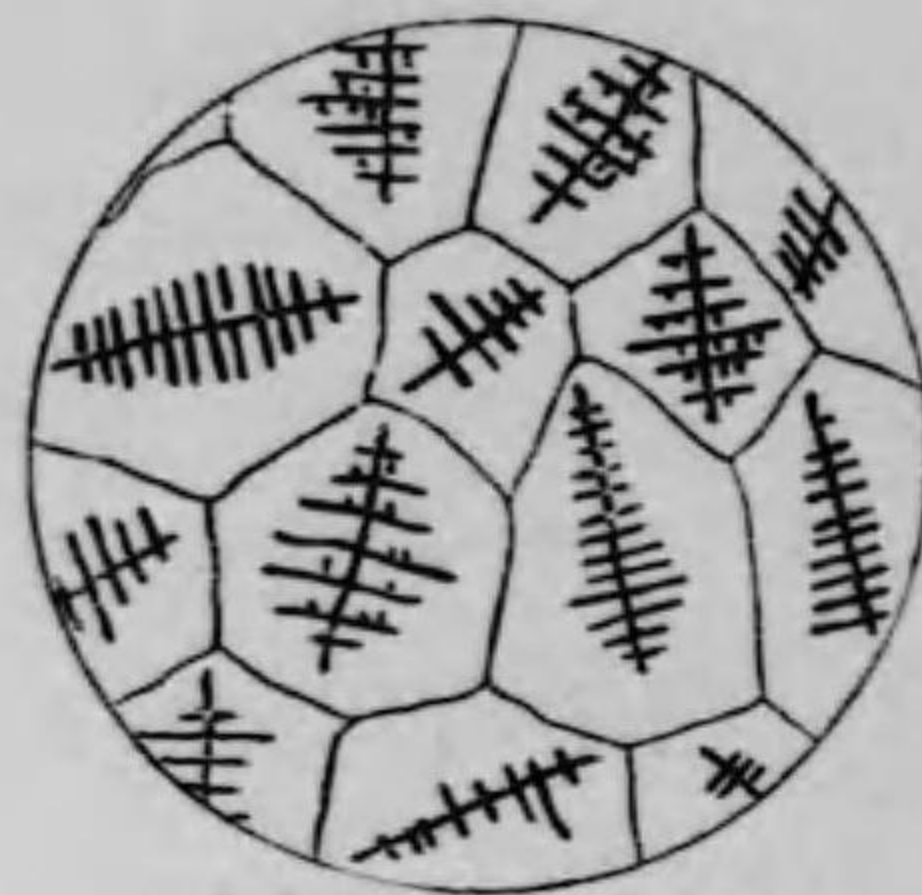
第二十圖……金屬の結晶する状態
