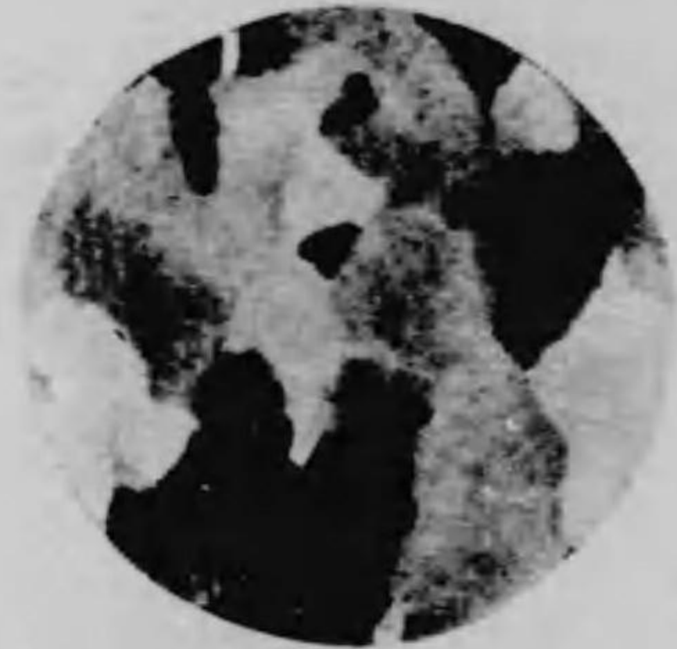
第十八圖……純粹の鐵を稍強く侵蝕したる場合
