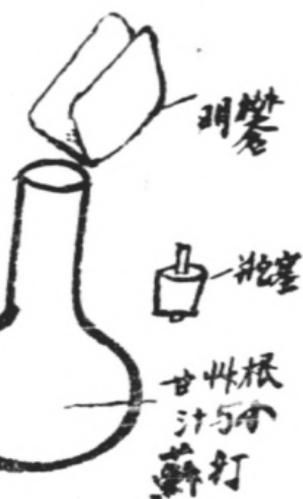
當 CO<sub>2</sub> 氣體衝出時，甘草根汁的泡沫跟着出來同時也含有一部份 NaHCO<sub>3</sub> 出來，一同蓋住了油類面上之後，可使之受熱繼續發出 CO<sub>2</sub>，同時把火燄所需要的氧氣隔絕，可以迅速滅火。
