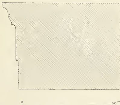
Abb. 222. Durchschnitt eines Keilsteins von der Südwand des Ekklesiasterion.
