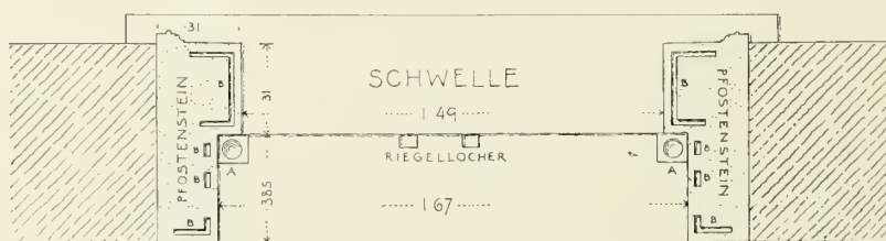
Abb. 323. Thürschwelle mit Pfostensteinen.
