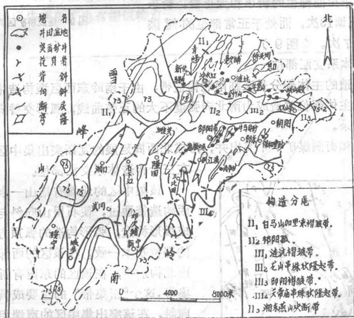
图8 涟邵煤田构造纲要及瓦斯突出矿井分布图
