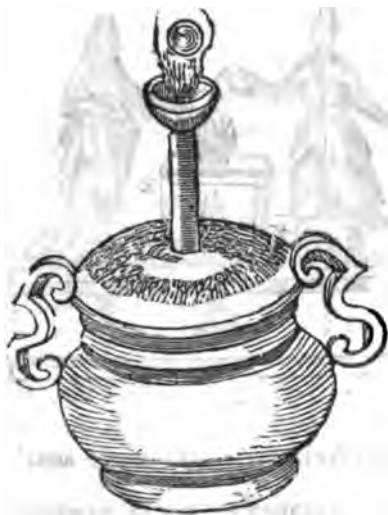
(Фиг. 2. паровой котель, бросающій вверхъ шарикъ.)
