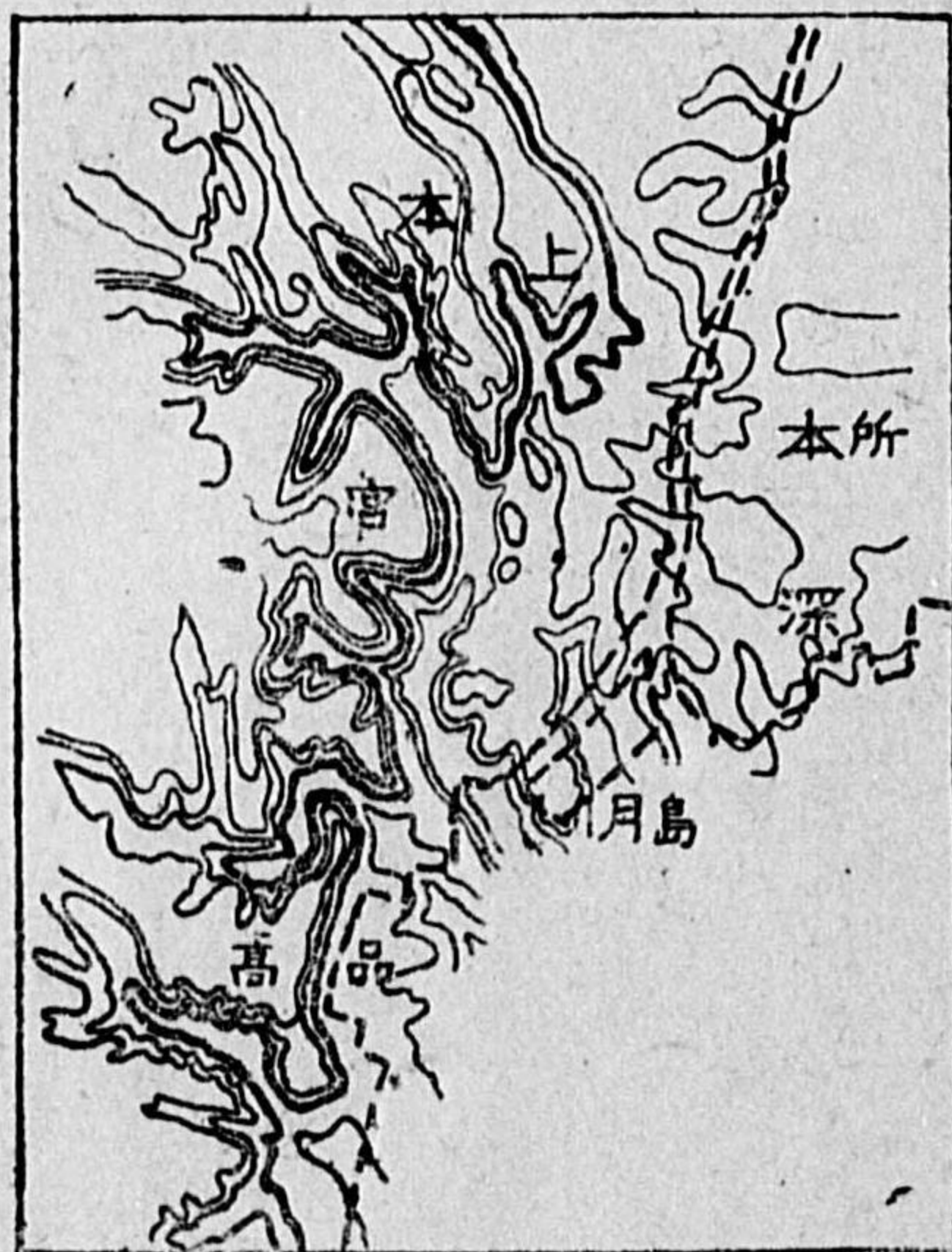
第5圖 沖積統(有樂町累層)を取り去つた時の東京。太線は現在の平均海面。等高線の距離 20 m.
