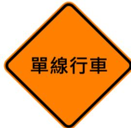
五、用於移動性施工，警告前方道路短暫施工或養護，車輛駕駛人應減速或變換車道行駛時，懸掛於工程車輛及機械之後方，背面斜插橙色旗幟二面或於車身明顯處加設閃光燈號。圖例如下：
