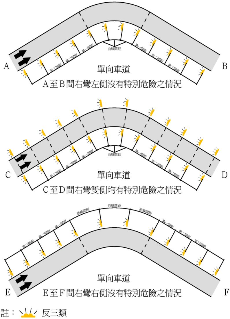
圖三 雙向車道曲線上反光導標之設置
