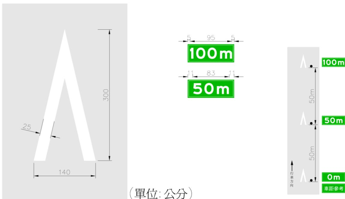
第一百八十八條 指向線，用以指示車輛行駛方向。以白色箭頭劃設於車道上。本標線設於交岔路口方向專用車道上與禁止變換車道線配合使用時，車輛須循序前進，並於進入交岔路口後遵照所指方向行駛。
