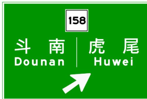
因受限制致無法依序設置「指31」、「指32」、「指33」等三出口預告標誌，除「指33」為必要設置，得僅於出口前一公里處設置「指32」標誌一面。出口動線複雜者，得以「指 33.1」設置；有標示間接通達需要者，得以「指33.1」或「指33.2」設置，其圖例如下：
