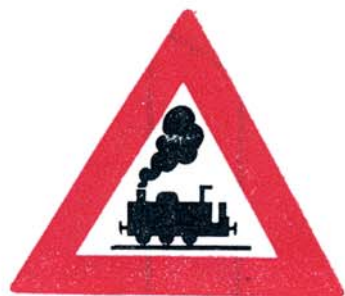
5 Železniční přejezd bez závor
