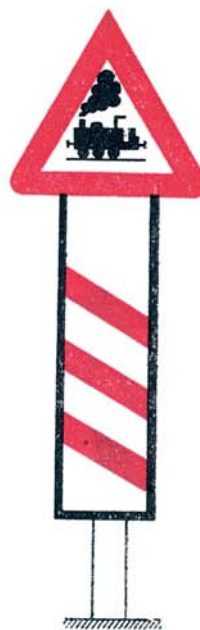
8b Návěstní deska pro železniční přejezd — vlevo
