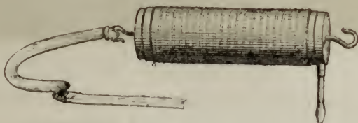
FIG. 50. — Cylindre élastique transmettant au polygraphe les mouvements respiratoires
