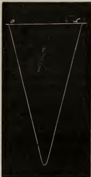
FIG. 94. — Graphique de l'élasticité du caoutchouc obtenu avec l'appareil enregistreur.
