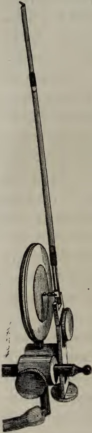
FIG. 41. — Levier du polygraphe articulé avec la membrane du tambour.
