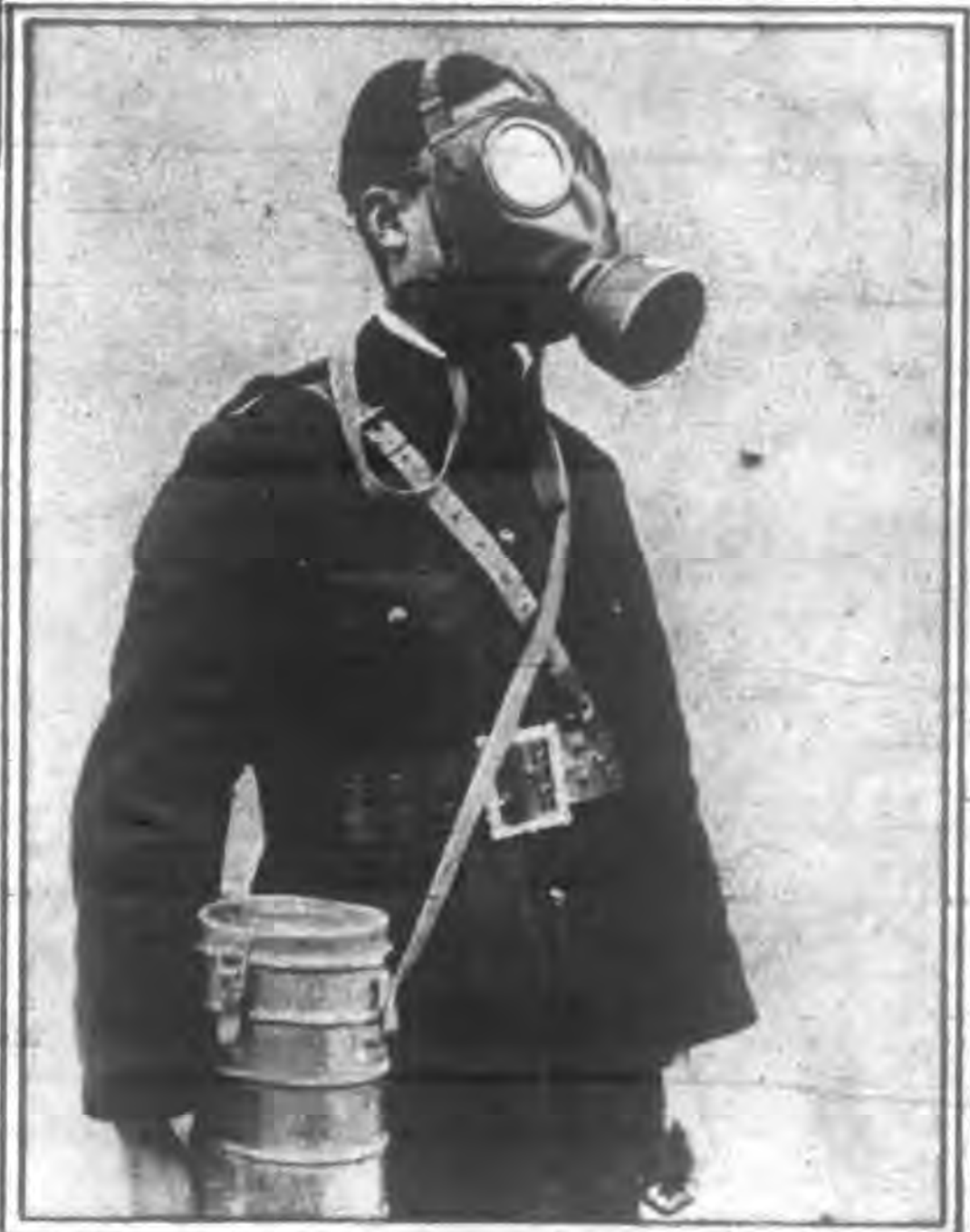
(上)德意志 式之防毒 面具—— 此種防毒 面具，以橡 皮布製成。 眼鏡框中 嵌有膠片。 冷天人口 中呼出之 汽水，不致 在鏡片上 凝爲水點， 妨礙視線。
